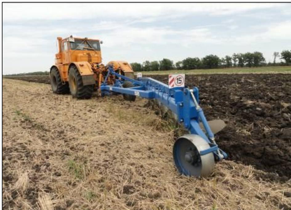
Рисунок 2 – Плуг навесной усиленный ПНУ-8-40 в агрегате с трактором К-701 на отвальной вспашке почвы (фон 1)
