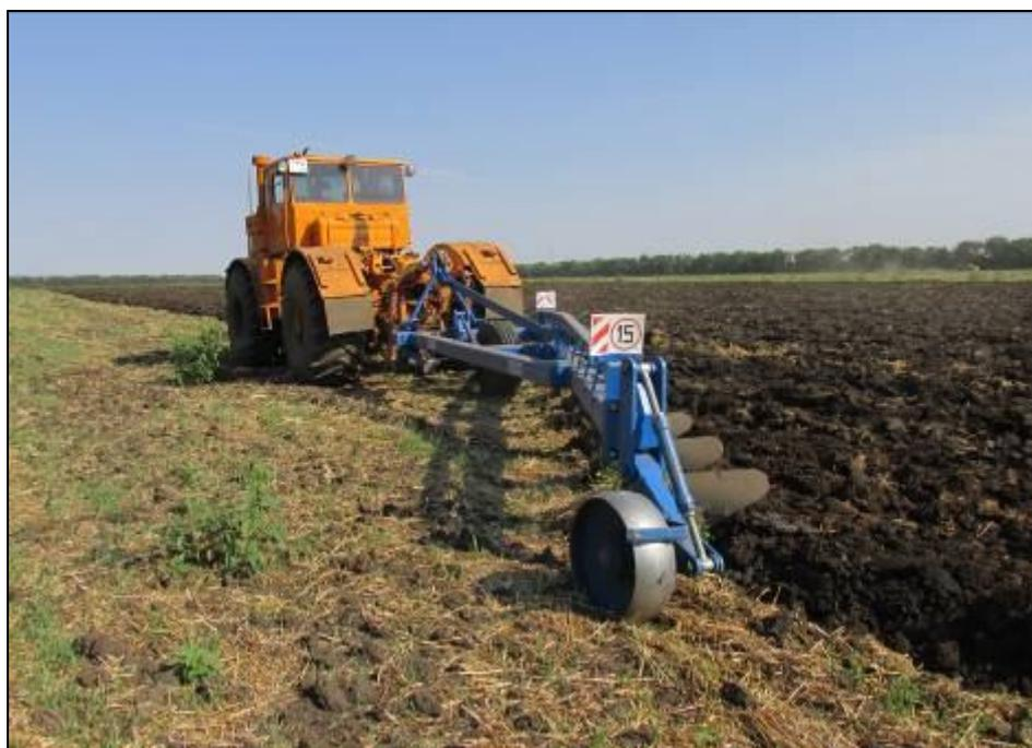
Рисунок 3 – Плуг навесной усиленный ПНУ-8-40 в агрегате с трактором К-701 на отвальной вспашке почвы (фон 2)
