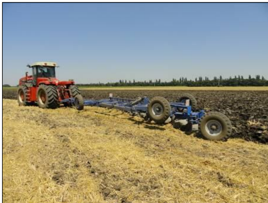
Рисунок 2 – Плуг ПП-(9+2)×35ЕП, в девятикорпусном варианте, в агрегате с трактором колесным Versatile 2375 на отвальной вспашке почвы (фон 1)
