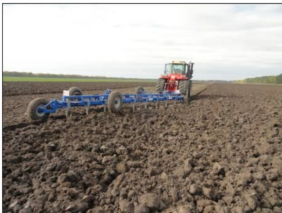
Рисунок 2 – Плуг ПП-(9+2)×35ЕП, в девятикорпусном варианте, в агрегате с трактором колесным Versatile 2375 на отвальной вспашке почвы (фон 2)
