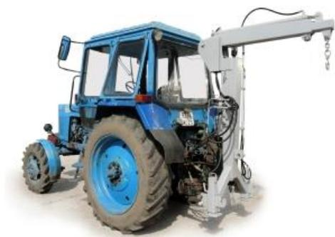
Подъемник навесной гидравлический ПНГ-1,5 предназначен для загрузки минеральными удобрениями машин для внесения минеральных удобрений, а так же может быть использован при различных погрузочно-разгрузочных работах в сельском хозяйстве.
