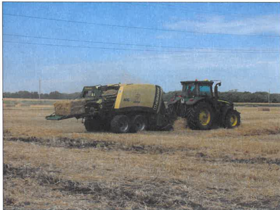
Рисунок 5 – Пресс-подборщик Big Pack 1270XS в агрегате с трактором John Deere 7830 на подборе и прессовании соломы озимой пшеницы
