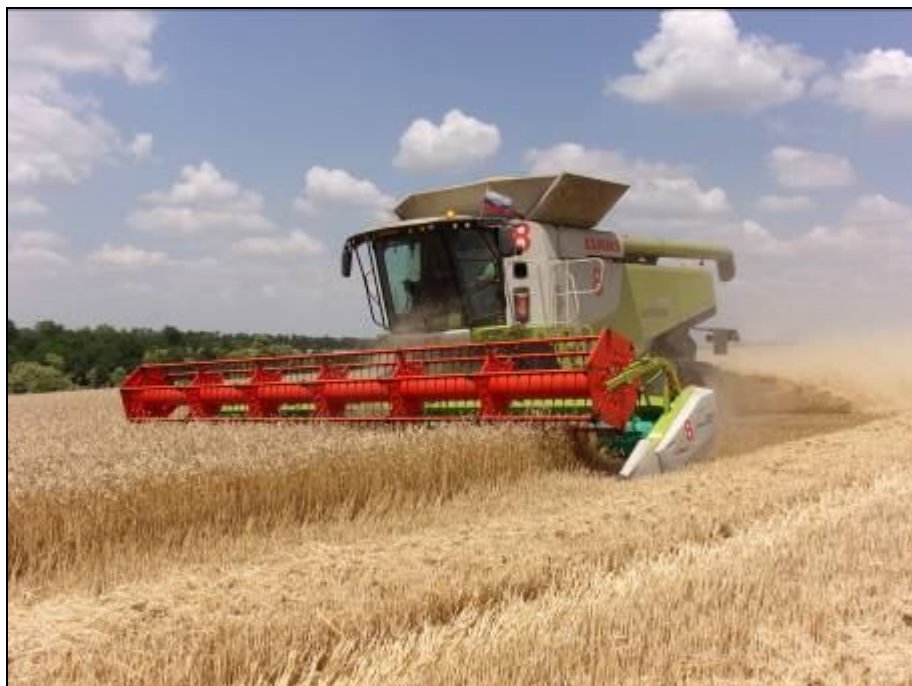
Рисунок 2 – Жатка MAXFLEX 930 с комбайном зерноуборочным LEXION 770, на прямом комбайнировании озимой пшеницы
