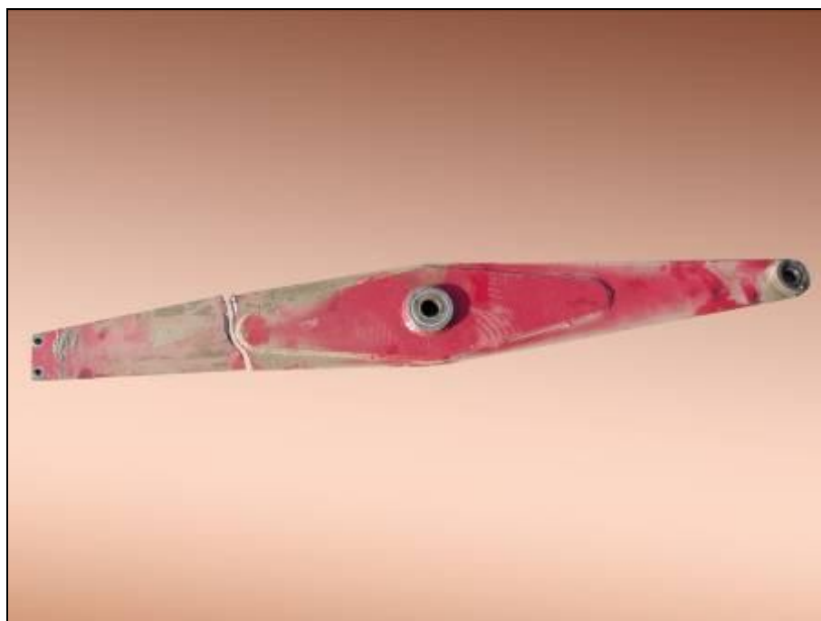
Рисунок А.2 – Излом по металлу коромысла (толщиной 8 мм) установки привода режущего аппарата
