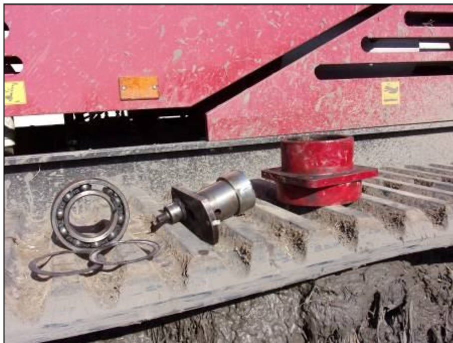
Рисунок А.1 – Разрушение подшипника контрпривода установки привода режущего аппарата
