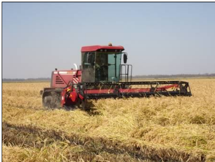
Рисунок 10 – Косилка на гусеничном ходу для уборки риса КС-150С на скашивании и укладке риса в валок
