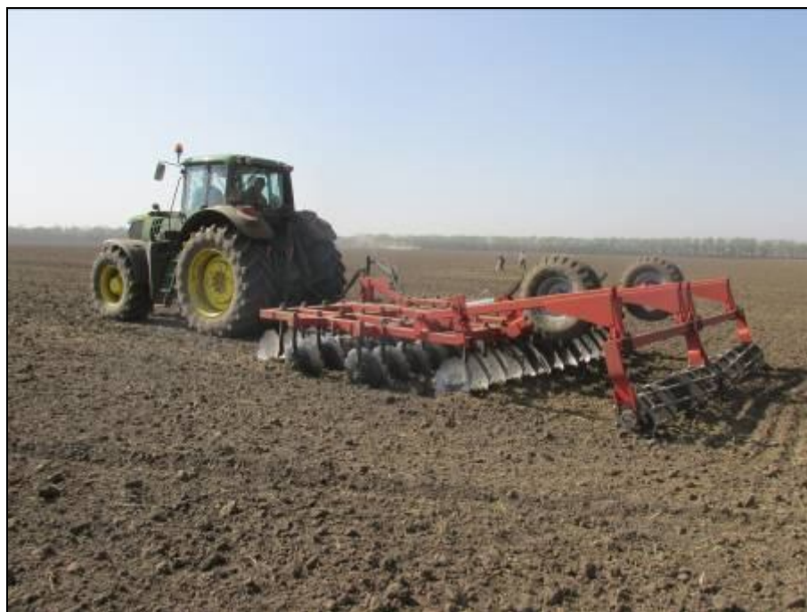
Рисунок 4 – Трактор колесный JOHN DEERE 6195M в агрегате с бороной дисковой БДТ-5М
