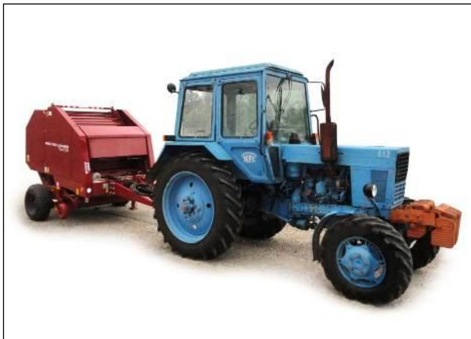
Рисунок 4 – Пресс-подборщик рулонный ППР-151 в агрегате с трактором МТЗ-82 в транспортном положении
