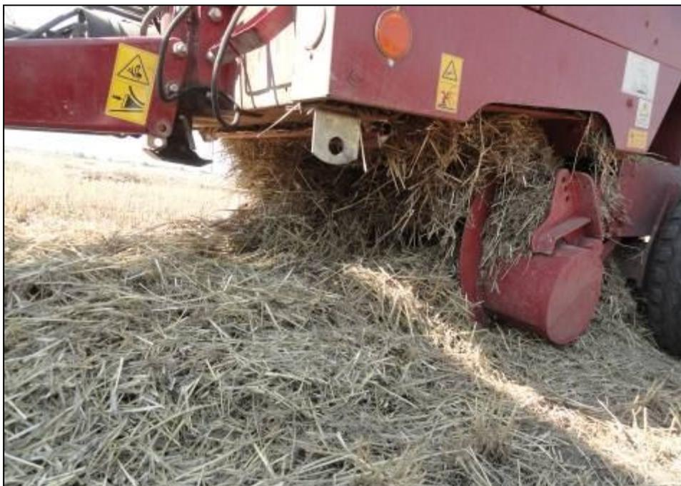
Рисунок 11 – Скопление массы в подбирающем механизме
