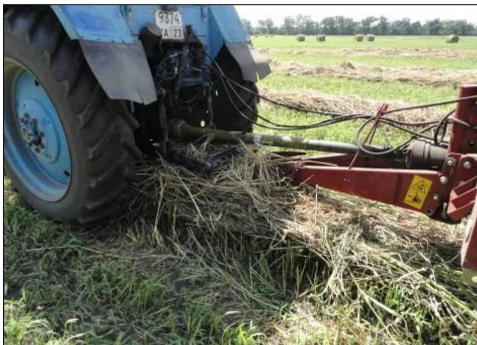
Рисунок 7 – Недостаток регулировки сннца пресс-подборщика для изменения пропускной способности
