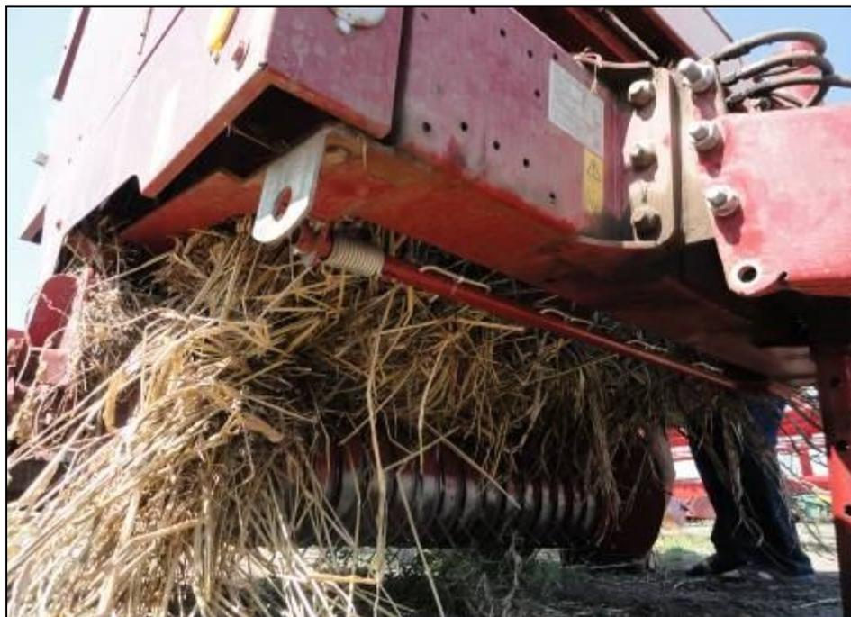
Рисунок 9 – Скопление массы в подбирающем механизме
