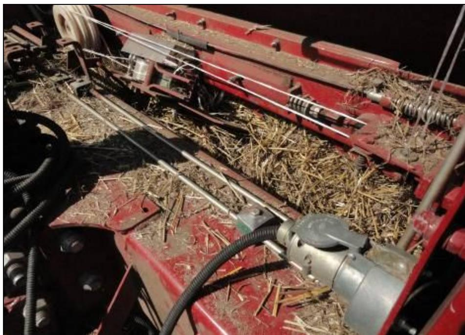
Рисунок 10 – Скопление массы в подбирающем механизме
