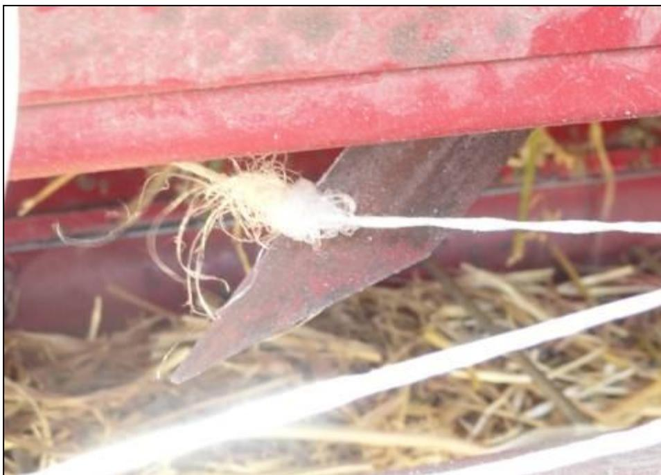
Рисунок 12 – Нестабильность резки шпагата
