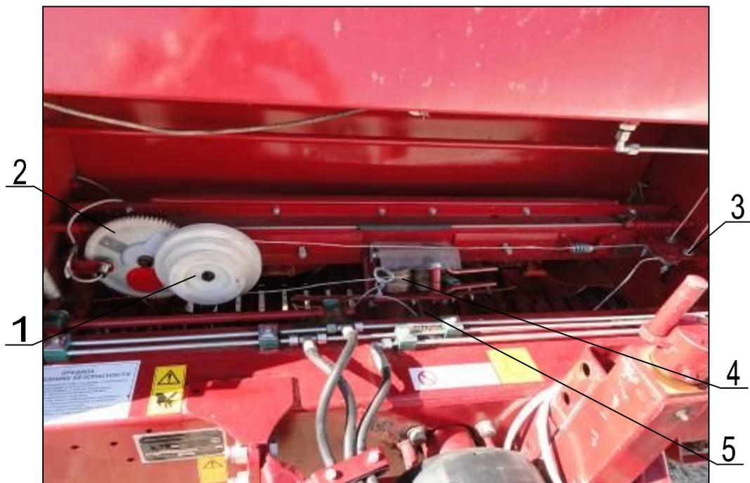
Рисунок 3 – Обвязывающий аппарат пресс-подборщика рулонного ППР-151:
