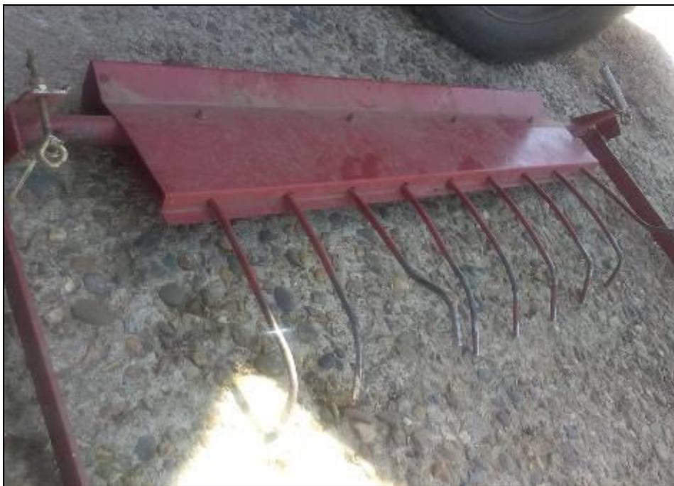
Рисунок 16 – Задевание граблей нормализатора об цепной транспортер
