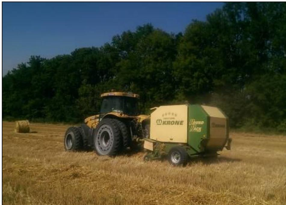
Рисунок 8 – Пресс-подборщик Round Pack Multi-Cut 1550 в агрегате с трактором Challenger MT575B на подборе и прессовании соломы озимой пшеницы
