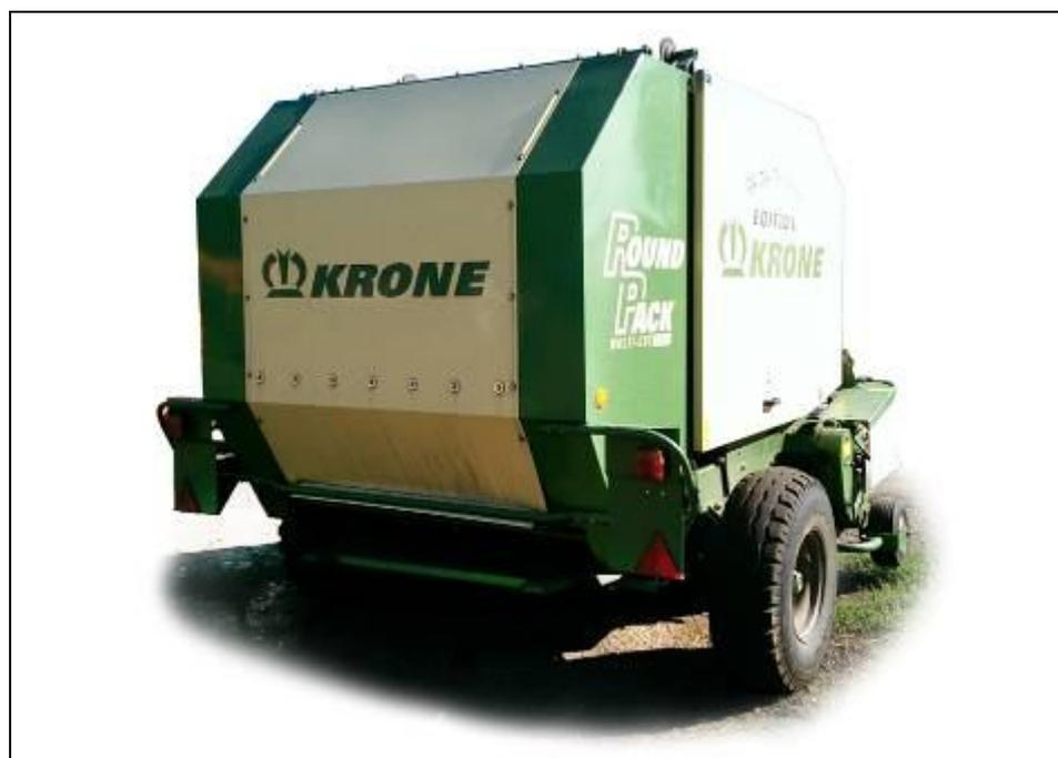
Рисунок 2 – Пресс-подборщик Round Pack Multi-Cut 1550, вид сзади справа
