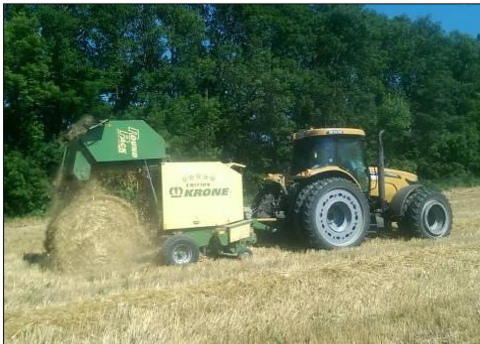
Рисунок 9 – Пресс-подборщик Round Pack Multi-Cut 1550 в агрегате с трактором Challenger MT575B. выгрузка рулона
