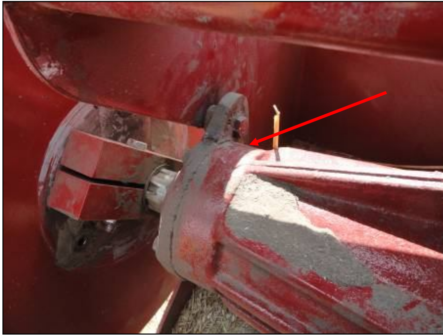
Рисунок А.1 – Обрыв крепления редуктора
