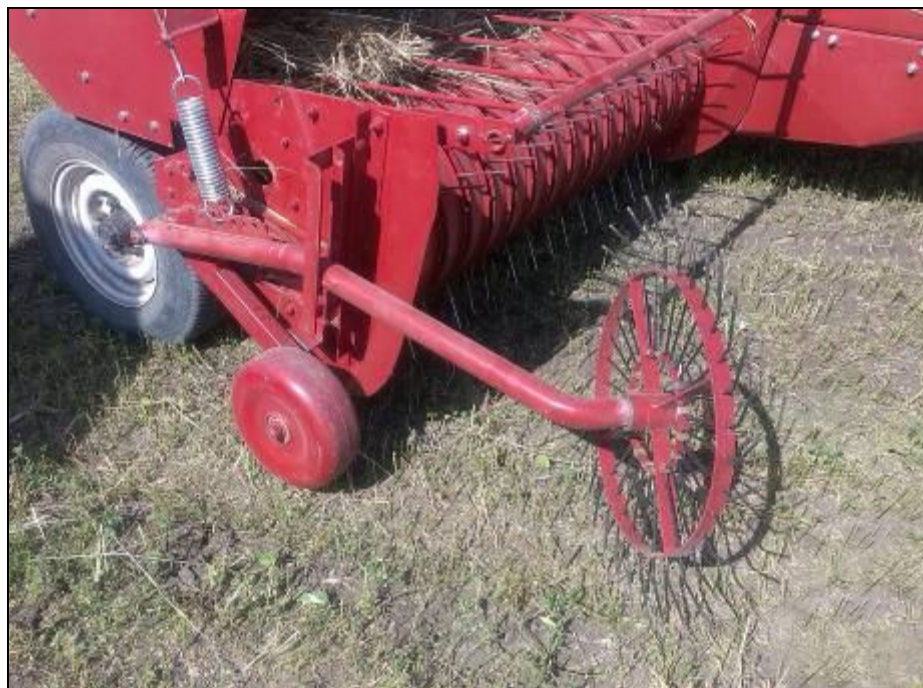
Рисунок 3 – Грабли-ворошилка пальцевого типа пресс-подборщика ПРТ-041
