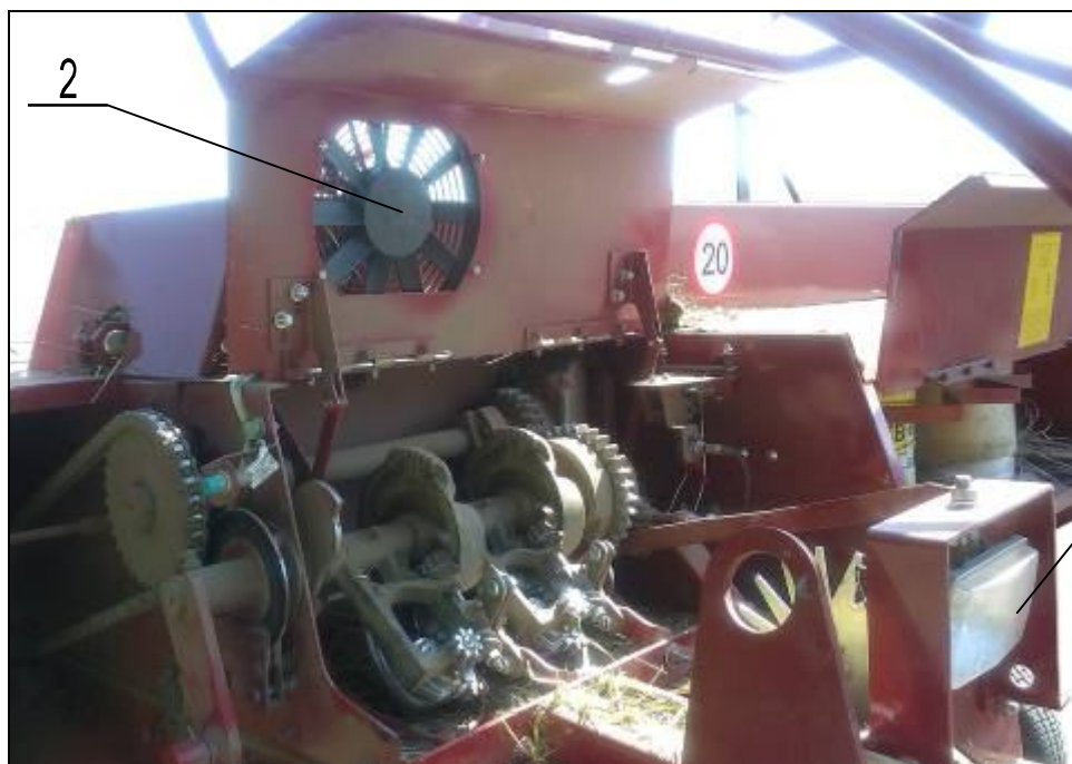
Рисунок 2 – Конструктивные изменения пресс-подборщика тюкового ППТ-041:
