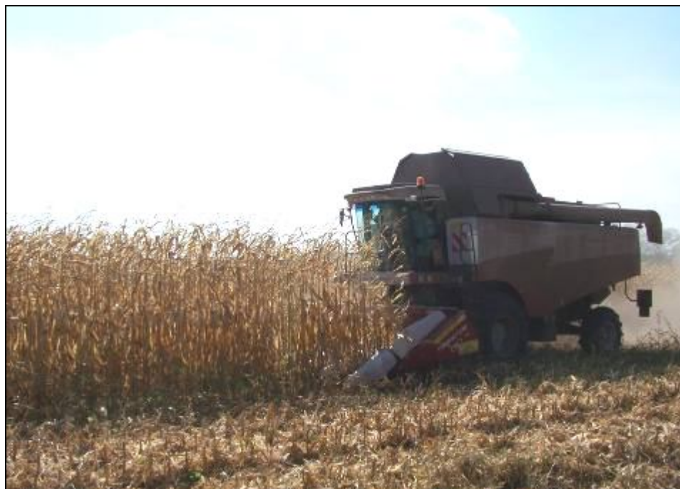
Рисунок 2 – Приспособление для уборки кукурузы на зерно "CORNMASTER 8" с комбайном РСМ-181 "TORUM-750" в работе
