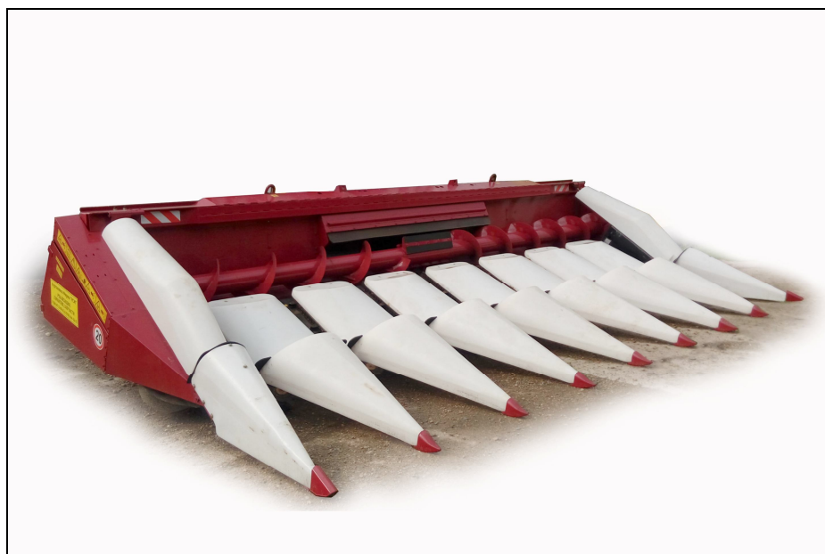
Рисунок 1 – Приспособление для уборки кукурузы МКК-80 "Cornmaster 8", вид спереди справа
