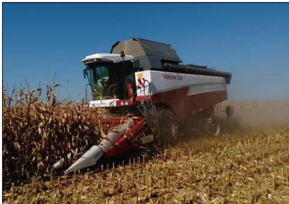
Рисунок 2 – Приспособление для уборки кукурузы МКК-80 "Cornmaster 8" в агрегате с зерноуборочным комбайном РСМ-181 "TORUM 760" в работе
