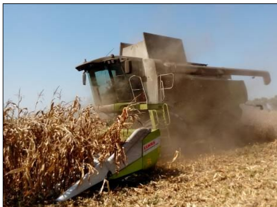
Рисунок 5 – Приспособление для уборки кукурузы Conspeed 12-70С в агрегате с комбайном LEXION 580 CLAAS в работе
