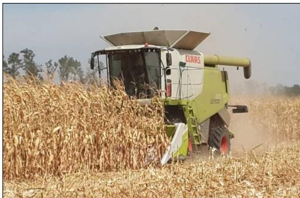
Рисунок 5 – Приспособление для уборки кукурузы на зерно
