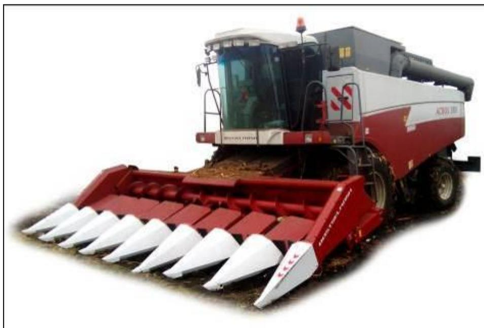
Рисунок 2 – Приспособление для уборки кукурузы на зерно ППК-81-54 в агрегате с комбайном РСМ-142 "ACROS-580", вид спереди слева
