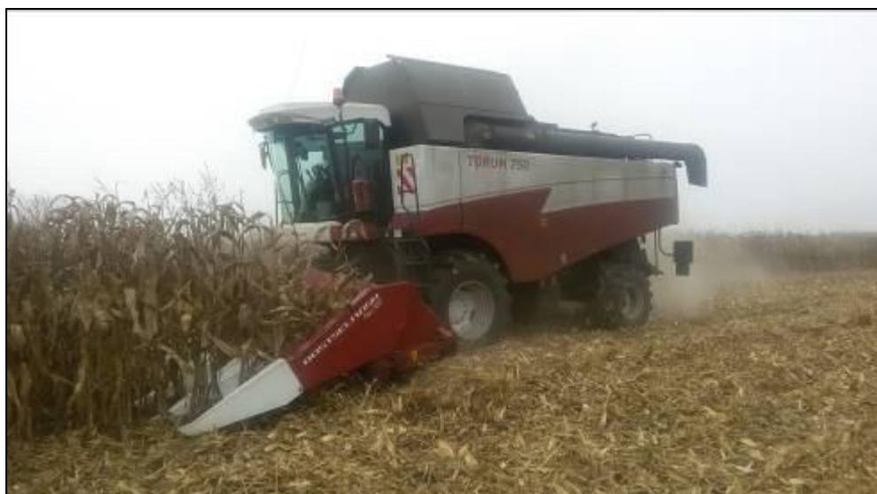
Рисунок 2 – Приспособление ППК-121-49 с комбайном зерноуборочным РСМ-181 "TORUM -750" на уборке кукурузы на зерно
