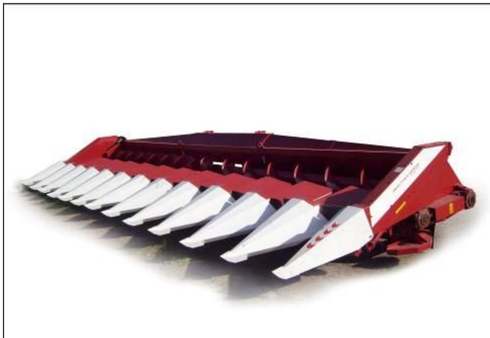
Рисунок 1 – Приспособление для уборки кукурузы ППК-121-49, вид спереди слева
