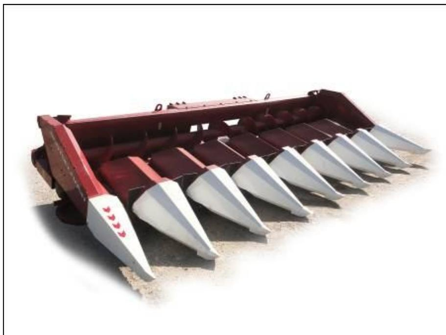
Рисунок 1 – Приспособление для уборки кукурузы ППК-81-01, вид спереди справа
