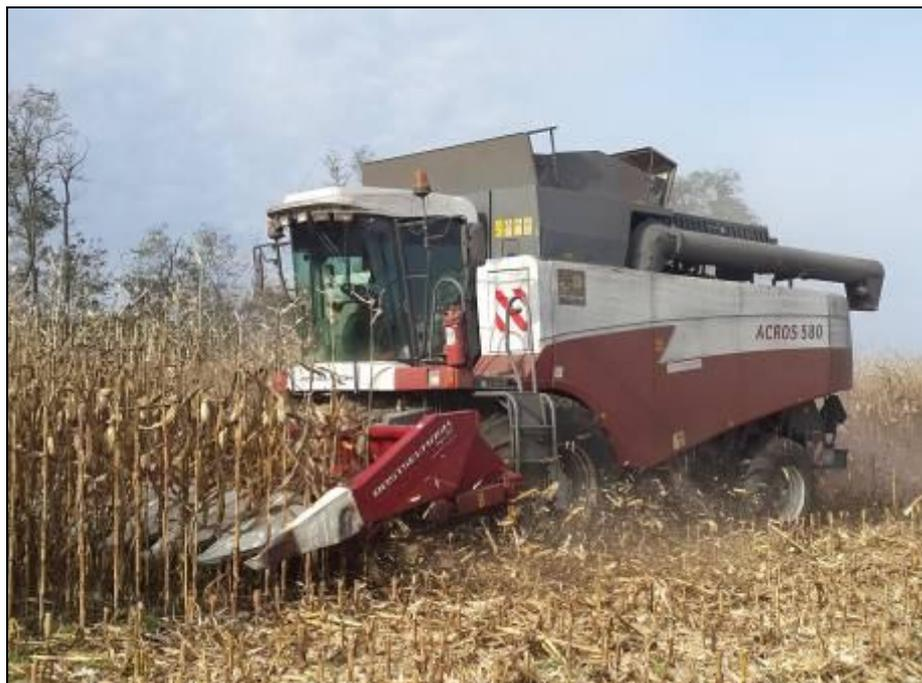
Рисунок 2 – Приспособление для уборки кукурузы ППК-81-01 в агрегате с зерноуборочным комбайном РСМ-142 "ACROS-580" на уборке кукурузы на зерно
