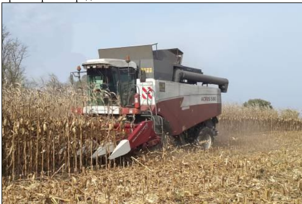
Рисунок 6 – Приспособление для уборки кукурузы ППК-81-54 в агрегате с комбайном зерноуборочным РСМ-142 "ACROS-580" на уборке кукурузы на зерно
