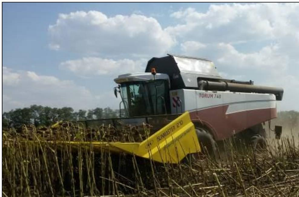
Рисунок 2 – Приспособление для уборки подсолнечника Sunmaster 1270, с комбайном РСМ-181 "TORUM-740" на уборке подсолнечника
