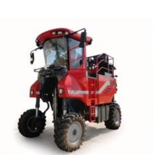
Комбайн виноградоуборочный самоходный EROSF-200 предназначен для уборки винограда технических сортов или плодов других культур, возделываемых подобным образом на равнинах и склонах. Комбайн осуществляет сьем урожая методом вибрации куста и шпалеры, производит накопление винограда в бункере с последующей выгрузкой в транспортное средство.
