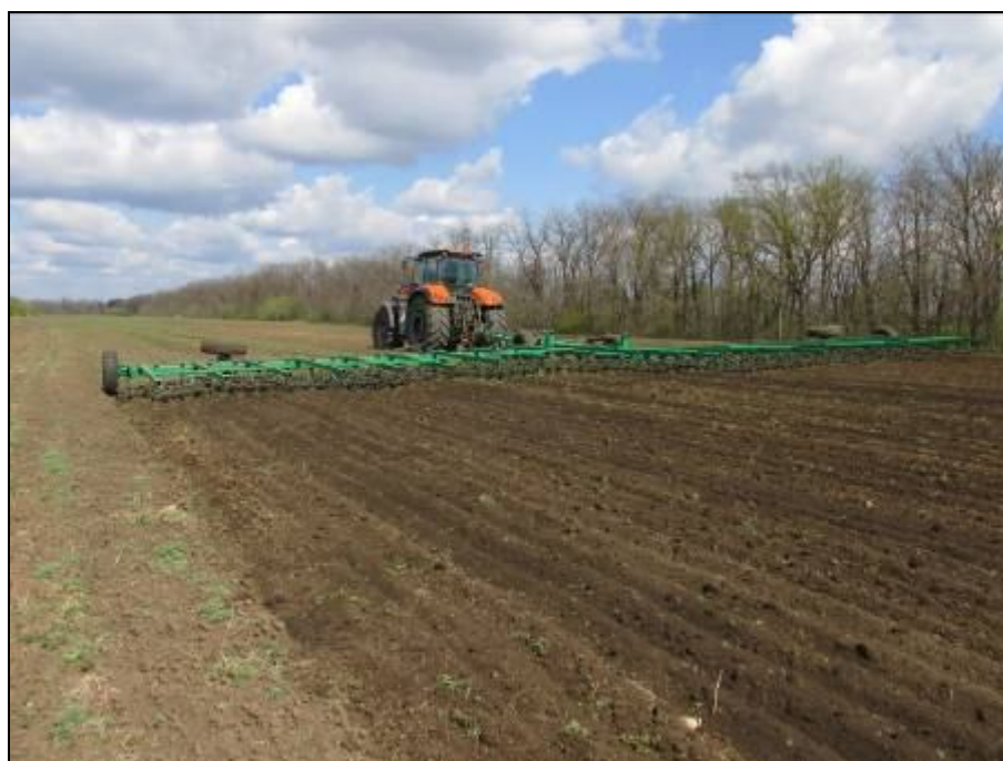
Рисунок 6 – Сцепка гидрофицированная выравниватель СГВ-21"Корммаш", в агрегате с трактором АТМ 7360, на бороновании почвы
