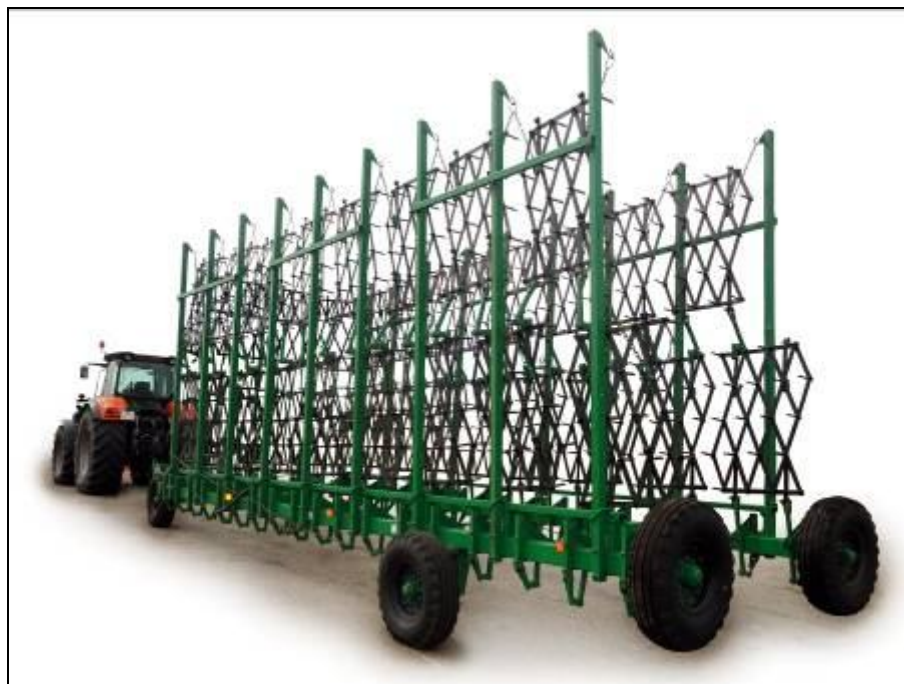
Рисунок 5 – Сцепка гидрофицированная выравниватель СГВ-21"Корммаш", в агрегате с трактором АТМ 7360, в транспортном положении
