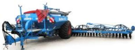
Сеялка зерновая пневматическая Солитэр 12/1200 К предназначена для рядового посева семян зерновых, зернобобовых, трав и других культур с одновременным прикатыванием.
