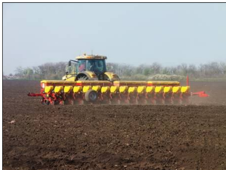
Рисунок 8 – Сеялка пропашная MS 8100 SUPER-L в агрегате с трактором Challenger MT 685Д на посеве подсолнечника
