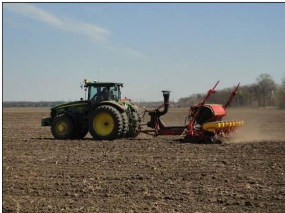
Рисунок 2 – Сеялка пропашная Темпо TPF 8
