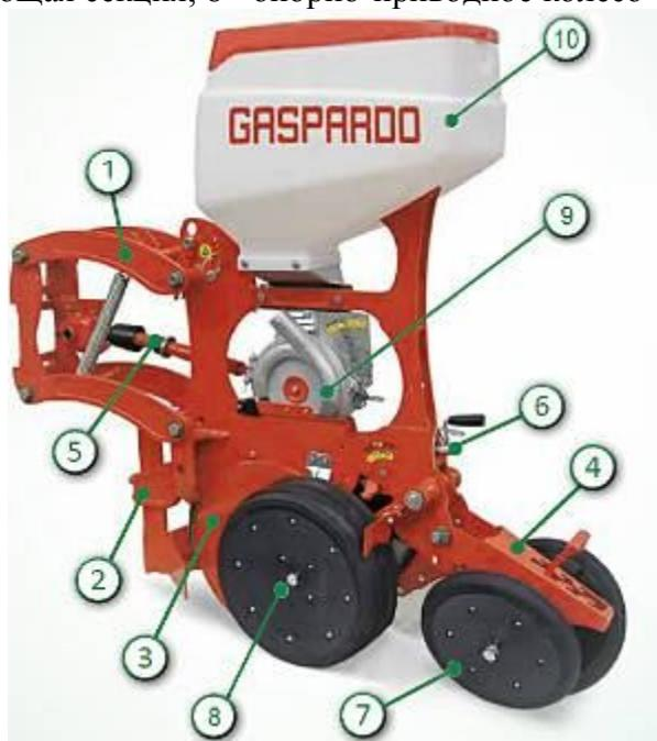
Рисунок 3 – Высевающая секция сеялки пропашной пневматической точного высева GASPARDO MTR 8 ROWS:
