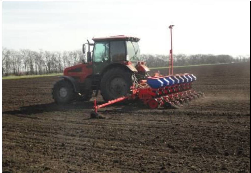
Рисунок 2 – Сеялка пропашная пневматическая точного высева ТС-М-8000А, в агрегате с трактором Беларус 1523, на посеве семян подсолнечника
