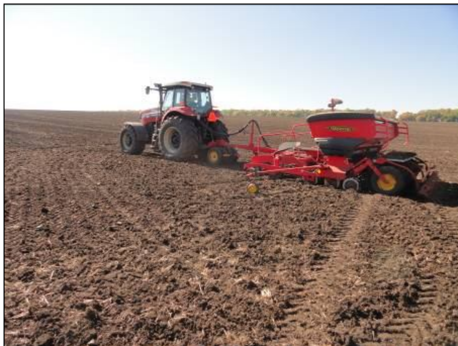
Рисунок 4 – Сеялка Rapid RD-400С в агрегате с трактором Versatile 280 на посеве озимой пшеницы
