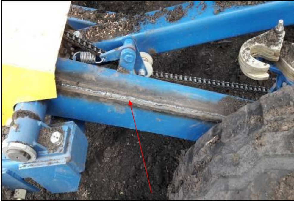
Рисунок А.1 – Сварка по месту поломки кронштейна опорно-приводного колеса
