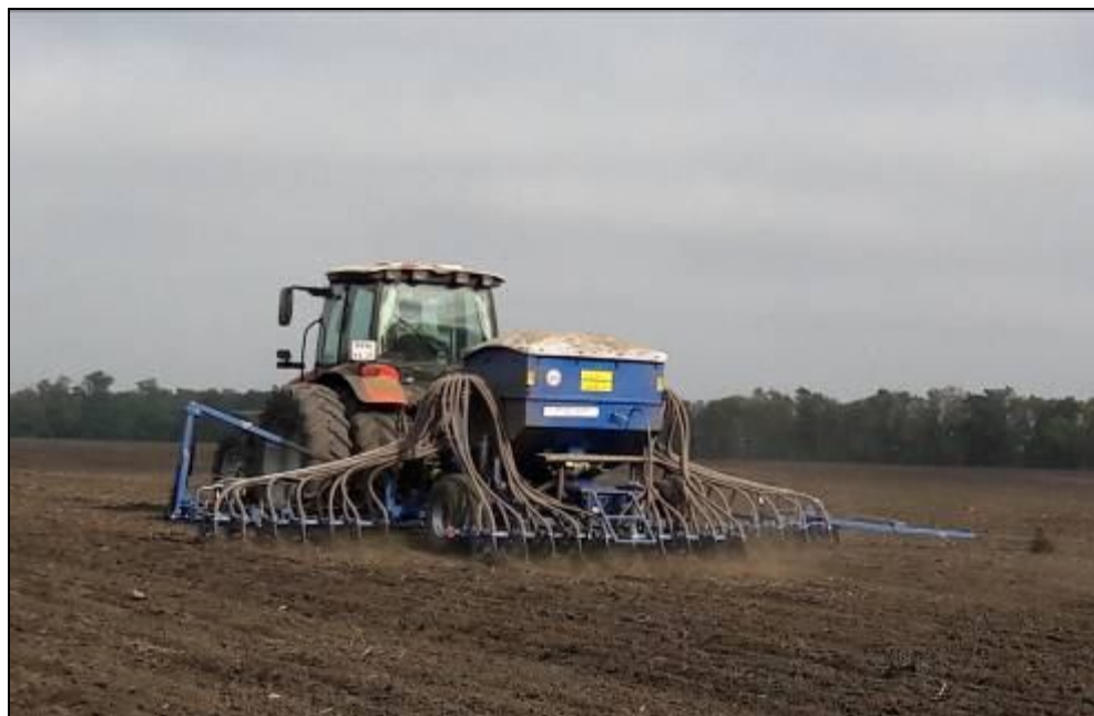
Рисунок 2 – Сеялка С-7,2 ПМЗ "Быстрица", в агрегате с трактором Беларус 1523, на посеве семян озимого ячменя
