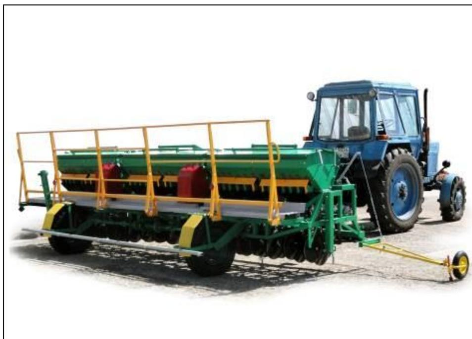
Рисунок 9 – Сеялка зерновая широкозахватная мобильная СЗШМ-5,4 "Дарья" в агрегате с трактором МТЗ-82 в рабочем положении, вид сзади справа
