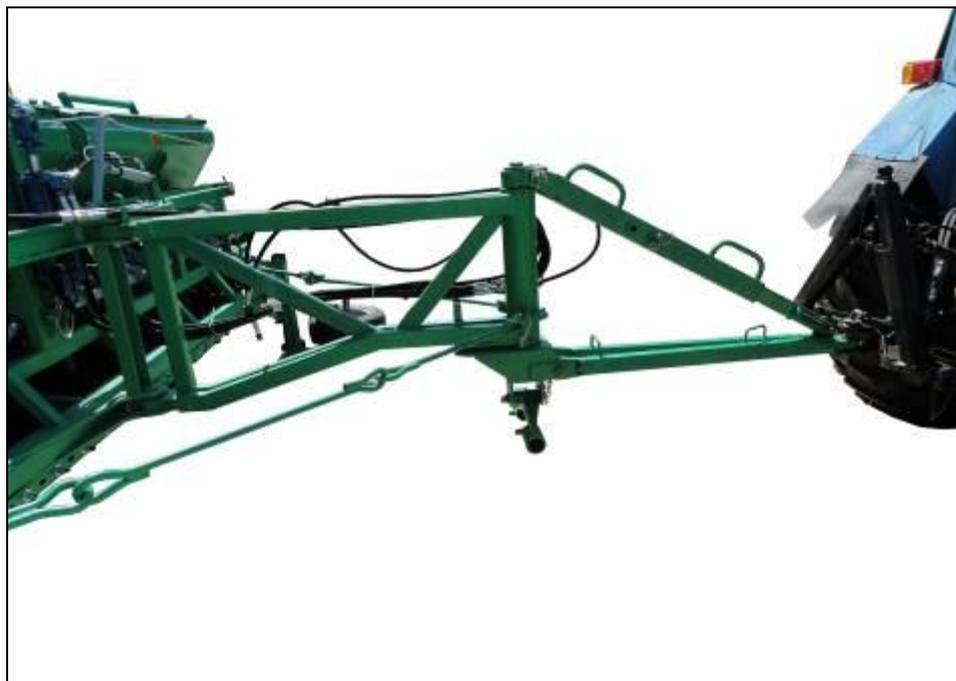
Рисунок 10 – Прицепное устройство сеялки зерновой широкозахватной мобильной СЗШМ-5,4 "Дарья", полуприцепной вариант
