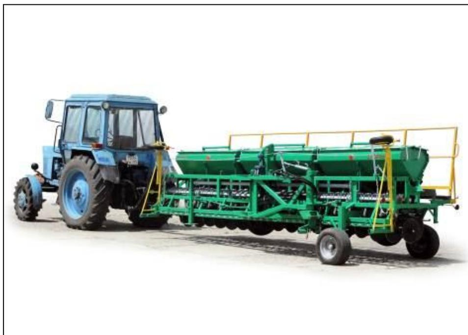
Рисунок 8 – Сеялка зерновая широкозахватная мобильная СЗШМ-5,4 "Дарья" в агрегате с трактором МТЗ-82 в транспортном положении, вид сзади слева
