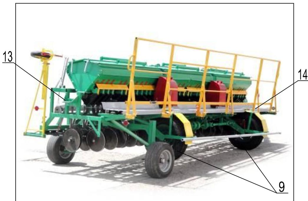
Рисунок 2 – Сеялка зерновая широкозахватная мобильная СЗШМ-5,4 "Дарья" (транспортное положение), вид сзади справа:
