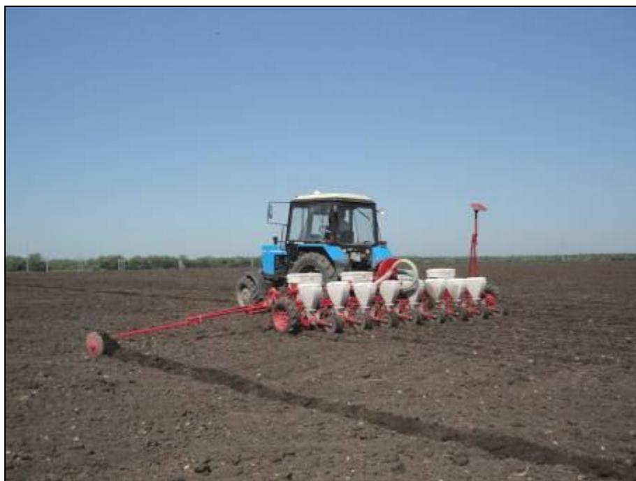
Рисунок 3 – Сеялка универсальная пневматическая
