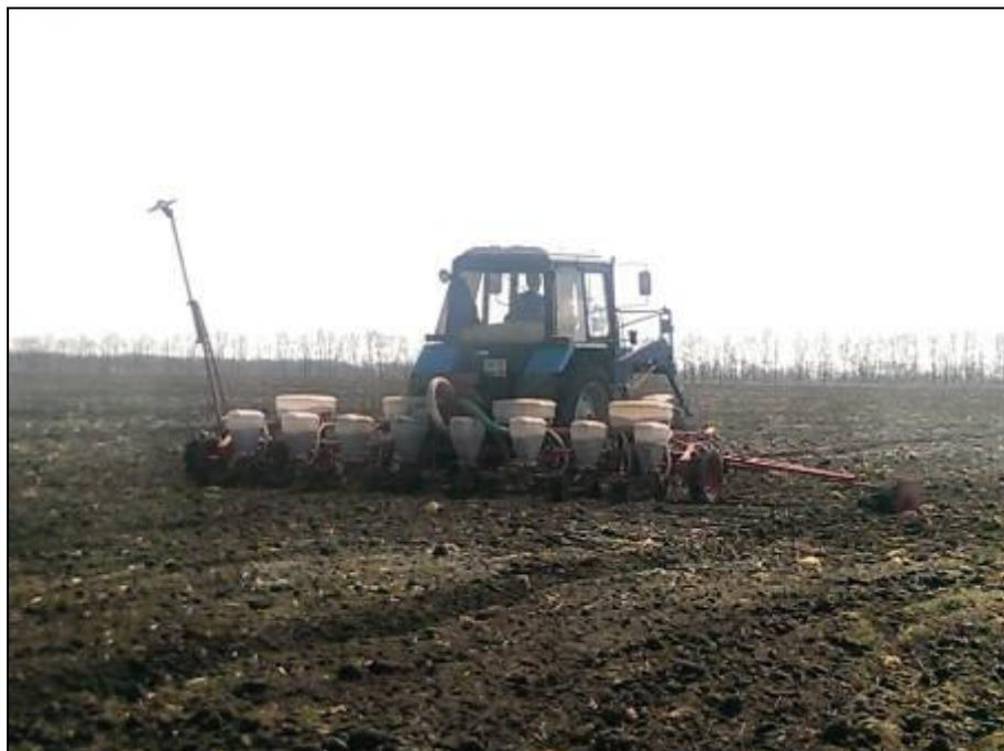
Рисунок 4 – Сеялка универсальная пневматическая
