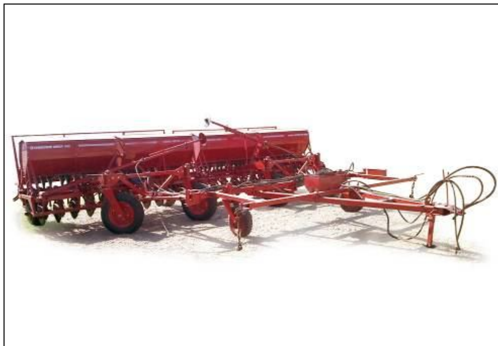
Рисунок 3 – Двухсеялочный агрегат сеялок зернотуковых прессовых СЗП-3,6Б со сцепкой прицепной СП-7, вид спереди справа
