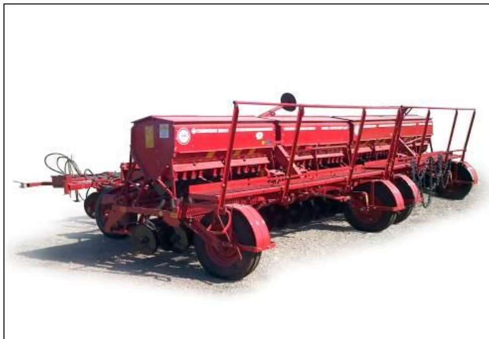
Рисунок 4 – Двухсеялочный агрегат сеялок зернотуковых прессовых СЗП-3,6Б со сцепкой прицепной СП-7, вид сзади слева
