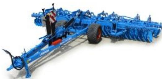
Системный носитель Гигант 10С/800 со сцепными устройствами и шасси, позволяющими осуществлять перевод агрегата из рабочего в транспортное положение и обратно, предназначен для составления гидрофицированных широкозахватных агрегатов. Системный носитель Гигант 10С/800 оснащенный гидравлическими трехточечными навесками на которые навешиваются бороны дисковые почвообрабатывающие Рубин 9/400 УПР и Рубин 9/400 УЛВ.
