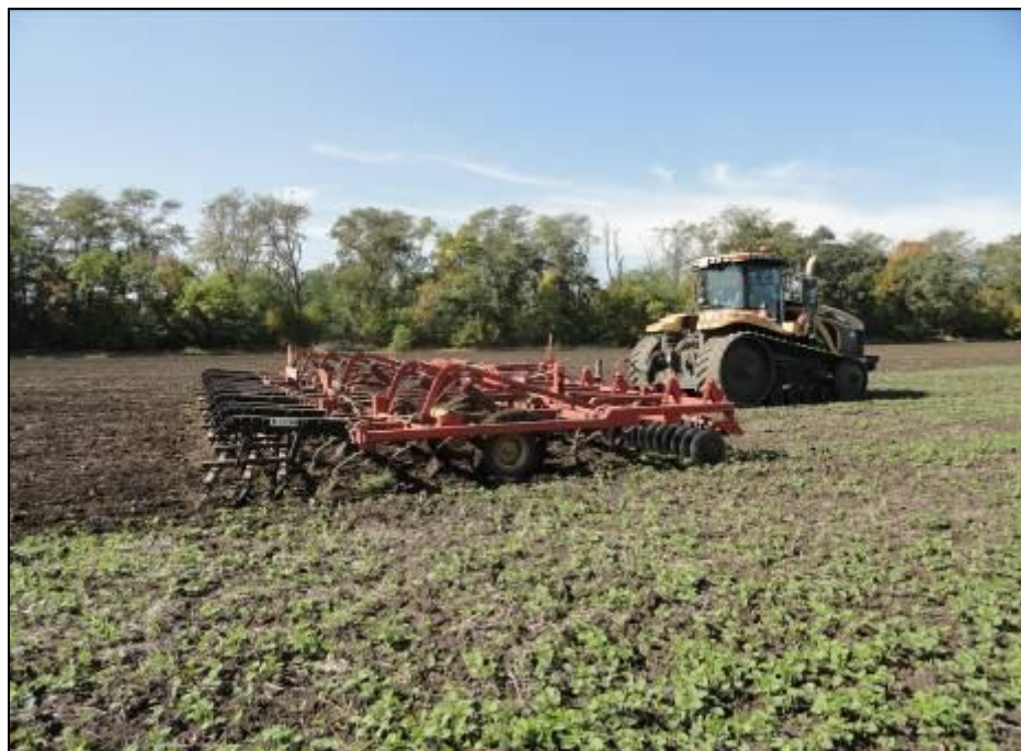
Рисунок 6 – Трактор Challenger MT 865С с культиватором KRAUSE TL 6200-42 на сплошной культивации почвы
