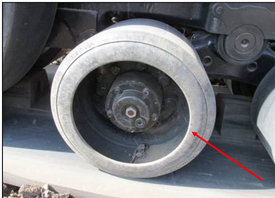
Рисунок А.1 – Опорный каток, замененный после расслоения резинового бандажа
