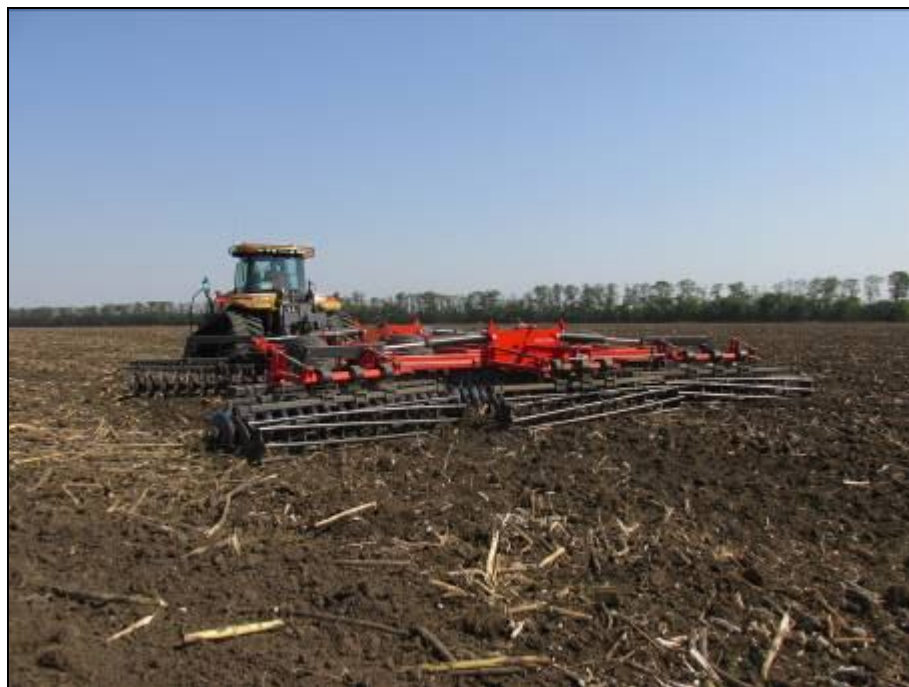
Рисунок 5 – Трактор Challenger MT 865 С в агрегате с бороной дисковой Gregoire Besson XXL на дисковом лушении стерни подсолнечника (2 след)
