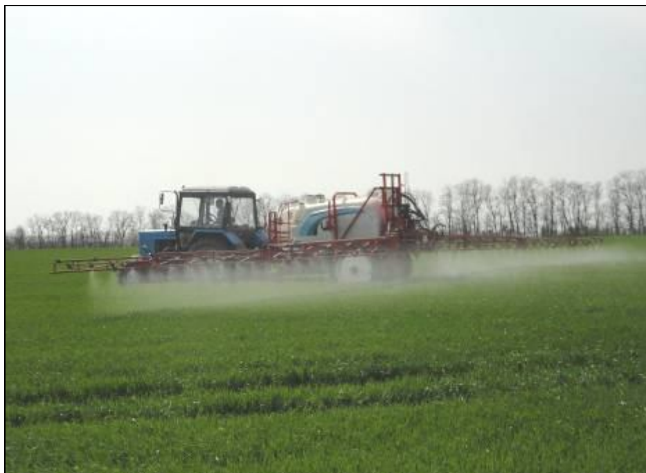
Рисунок 3 – Трактор Беларус 82.1 в агрегате с опрыскивателем Baram Elios 3000 на внесении гербицидов по посевам озимой пшеницы
