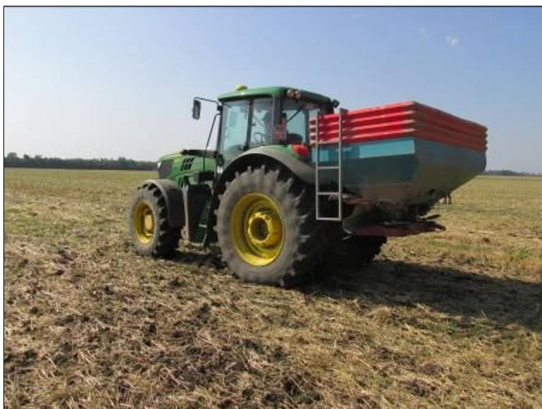
Рисунок 6 – Трактор John Deere 6150М в агрегате с разбрасывателем минеральных удобрений Sulky DPX
