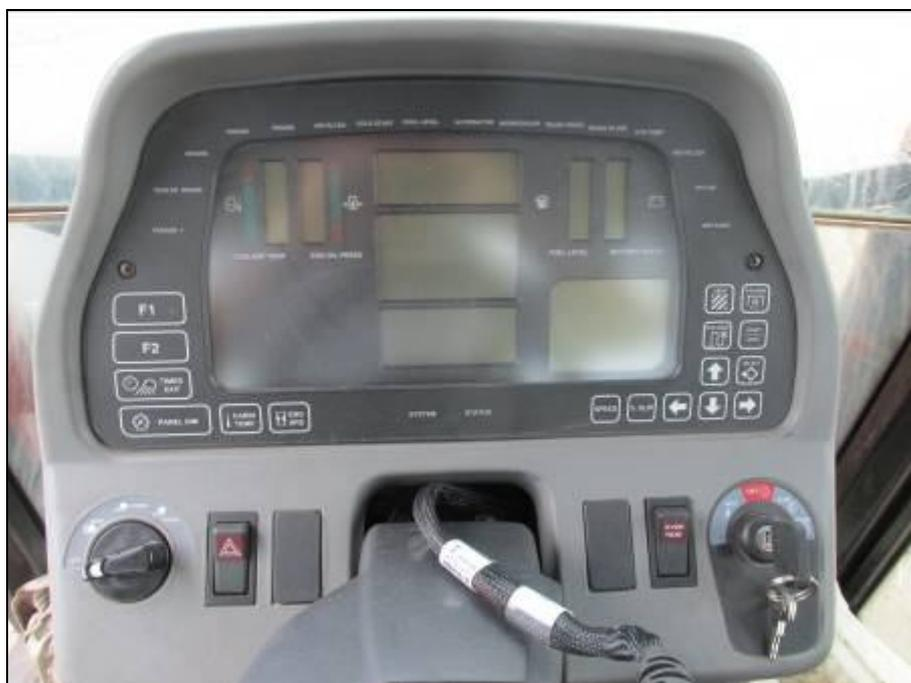
Рисунок 4 – Трактор колесный Versatile 280, электронная приборная панель
