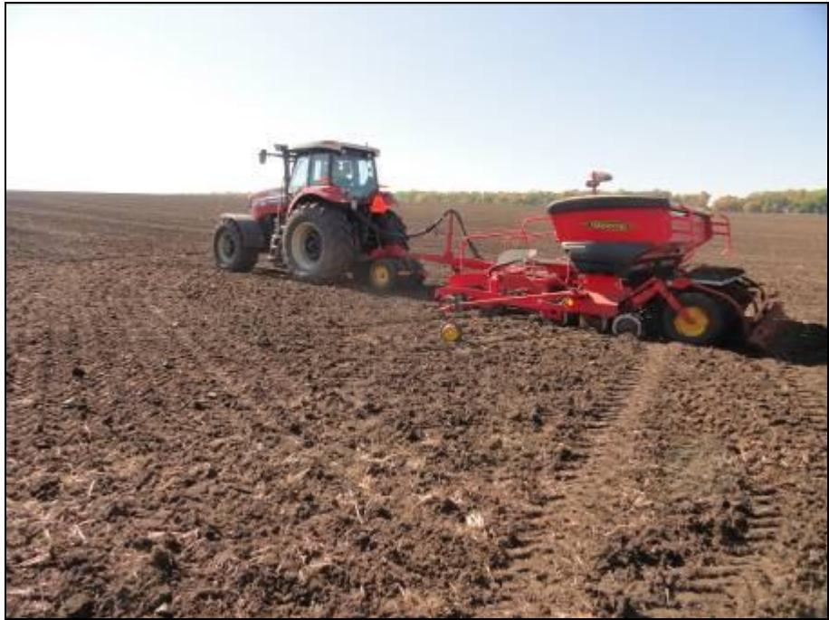
Рисунок 7 – Трактор колесный Versatile 280 с сеялкой
