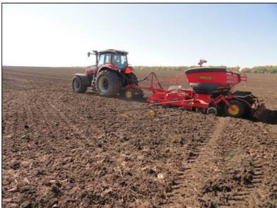
Рисунок 7 – Трактор колесный Versatile 280 с сеялкой Rapid RD-400С на посеве озимой пшеницы
