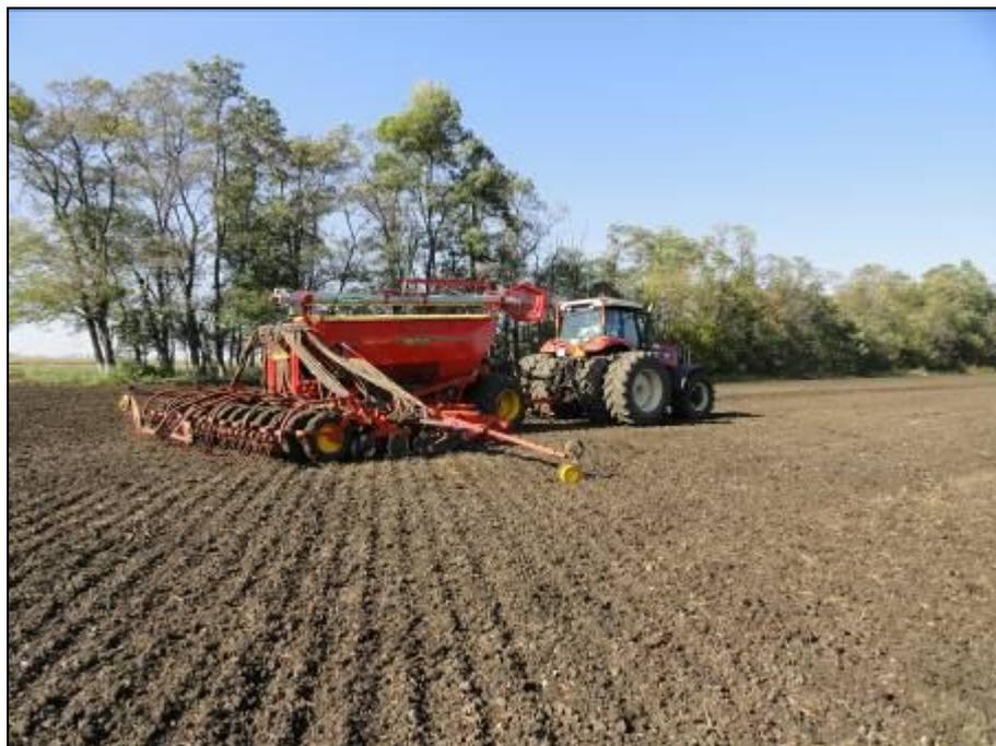
Рисунок 6 – Трактор колесный Versatile 305 в агрегате с сеялкой Rapid RDA-600С на посеве озимой пшеницы
