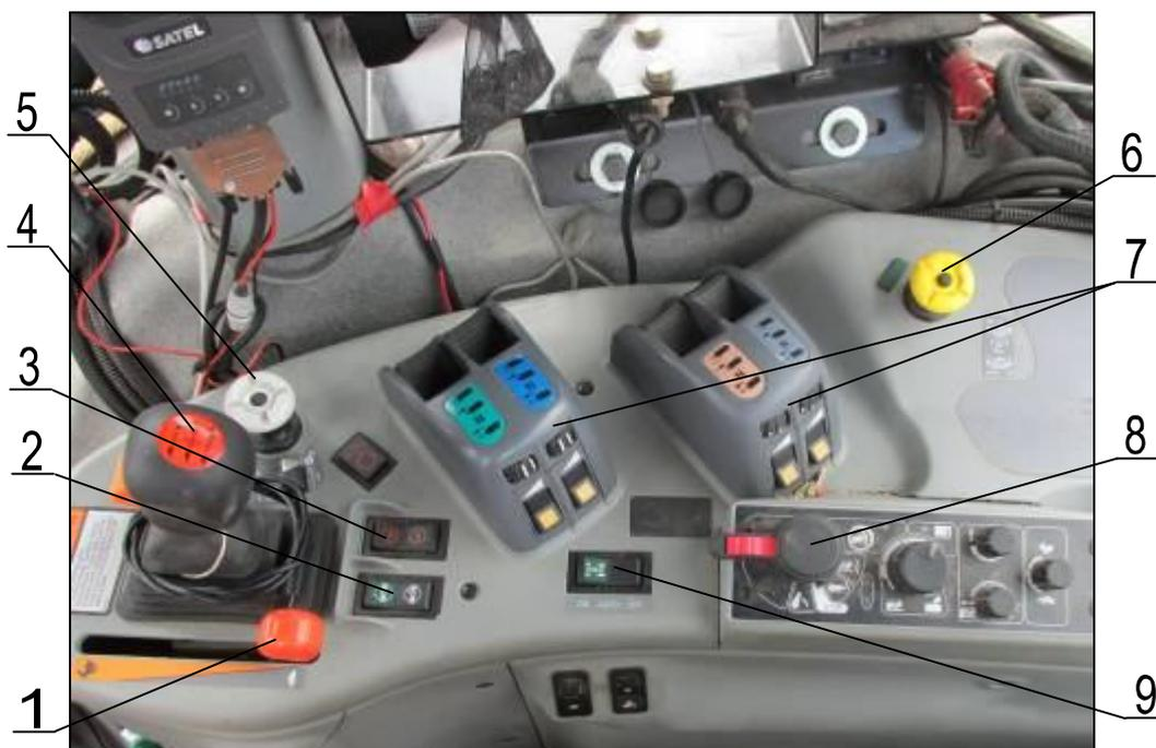
Рисунок 3 – Органы управления правой панели трактора колесного Versatile 305:
