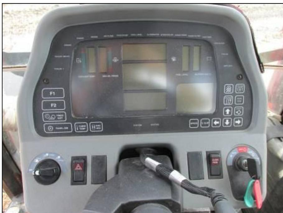
Рисунок 2 – Электронная приборная панель трактора колесного
