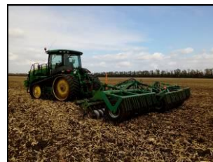
Трактор John Deere 8320 RT в агрегате с дисковой бороной Amazone Catros 7501-T, на дисковом лущении стерни кукурузы (3-й след) (фон 2)
