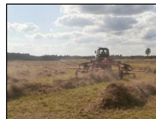
Грабли SP-772D в агрегате с трактором Беларус 82.1 на сгребании в валки сухой массы многолетних трав
