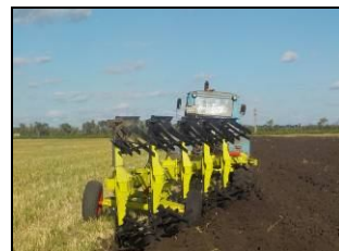
Плуг в работе в агрегате с трактором ОрТЗ-150К
