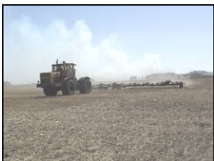
Борона БТ-18.М в агрегате с трактором К-701 на предпосевном бороновании
