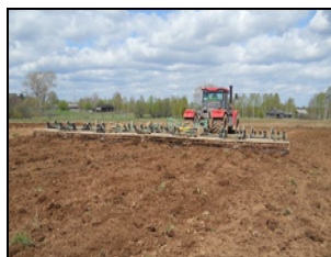
Культиватор прицепной комбинированный КПК-12, в агрегате с трактором Кировец К-744 Р2 на культивации пласта многолетних трав
