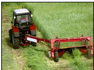
Косилка ротационная прицепная КРП-3200 в агрегате с МТЗ-82.1, на кошении злаковых трав
