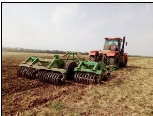
Борона дисковая тяжелая БДК-5,4М в агрегате с трактором К-744РЗ "Кировец" на дисковом лушении стерни озимой пшеницы (2-й след)
