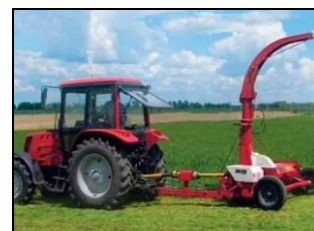
Комбайн КСД-2,0 в агрегате с трактором МТЗ-82 на скашивании и измельчении злаковой смеси
