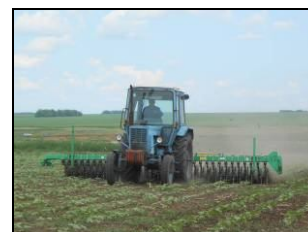
Борона-мотыга БМТ-6 в агрегате с трактором МТЗ-80 на бороновании посевов подсолнечника
