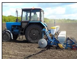
Сеялка СНПП-5,6К в агрегате с трактором МТЗ-82 на посеве семян подсолнечника
