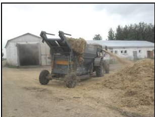
Измельчитель рулонов ИР-1,8 в агрегате с трактором Беларус-1025.2 на измельчении рулонов соломы
