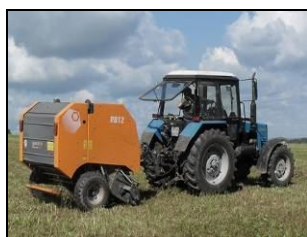
Пресс-подборщик RB12/2000 NW в агрегате с трактором Беларус 1025.2 на подборе валков и прессование рулонов с обвязкой сеткой
