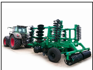
Борона дисковая тяжелая БДК-5,4М в агрегате с трактором Fendt 936, в транспортном положении
