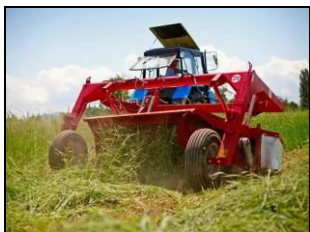
Косилка ротационная прицепная КРП-3200 на кошении злаковых трав
