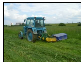
Косилка дисковая навесная КДН-210 в агрегате с трактором МТЗ-82.1 на кошении трав первого укоса
