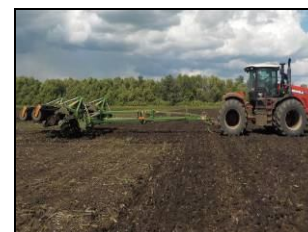
Борона дисковая Catros 9001-KR в агрегате с трактором VERSATILE 425 на дисковании почвы
