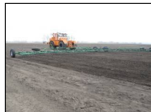
Борона средняя пружинная БС-24М в агрегате с трактором К-700А на ранневесеннем бороновании
