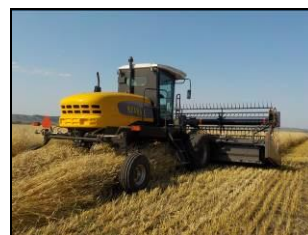
Косилка КС-100 "Чулпан" в агрегате с жаткой ЖВ-760 в работе на скашивании озимой ржи
