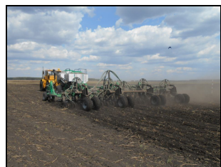
Посевной комплекс "КУЗБАСС-Т" ПК-8,5 в агрегате с трактором К-701 на посеве пшеницы
