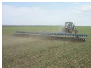
Борона мотыга ротационная БМР-12 в агрегате с трактором МТЗ-80 на бороновании всходов гороха
