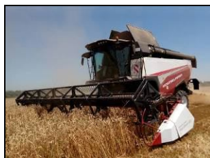
Жатка соевая универсальная ЖСУ-900 с зерноуборочным комбайном РСМ-161 на уборке озимой пшеницы (фон 1)
