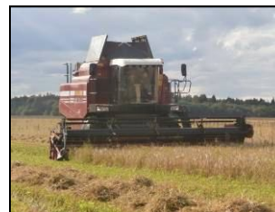
Комбайн зерноуборочный самоходный КЗС-1218А-1 с жаткой ЖЗК-7-5 на уборке пшеницы
