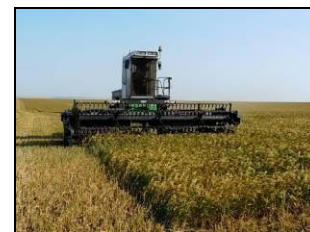
Жатка зерновая валковая SH-309 в агрегате с косилкой "Мещера Е-403" на скашивании ячменя
