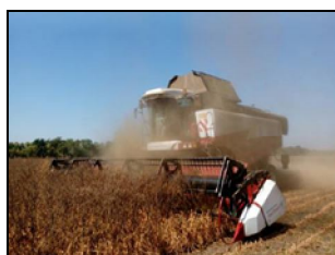
Жатка соевая универсальная ЖСУ-900 с зерноуборочным комбайном РСМ-181 "Торум-750" на уборке сои (фон 2)
