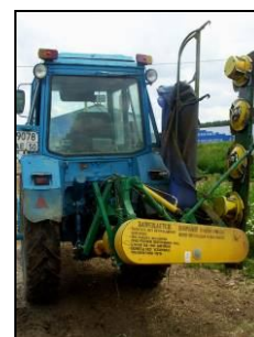
Косилка дисковая навесная КДН-210 в агрегате с МТЗ-82.1 в транспортном положении
