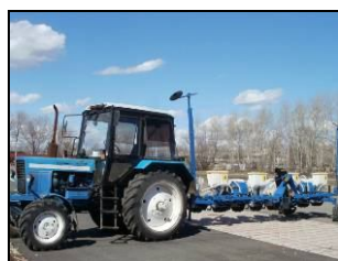
Сеялка СНПП-5,6К в агрегате с трактором МТЗ-82 в транспортном положении
