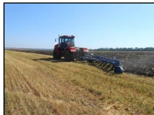
Плуг ПНУ-8х40П в агрегате с трактором К-744Р1 на вспашке зяби
