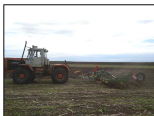
Борона дисковая прицепная БДП-5,2 в агрегате с трактором Т-150К на дисковании стерни подсолнечника
