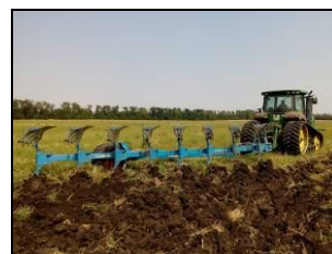
Трактор John Deere 8320 RT в агрегате с плугом Lemken Diamant 11 OF на отвальной вспашке почвы, после дискового лущения стерни озимой пшеницы (фон 1)
