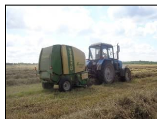
Пресс-подборщик рулонный Fortima F1250 MC в агрегате с трактором Беларус 1221.на подборе и прессовании сена с обмоткой сеткой
