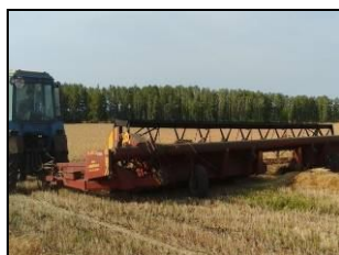
Жатка ЖВЗ-10,7-04 в агре- гате с трактором МТЗ-80 на скашивании и укладке в валок
