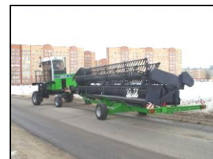
Самоходная косилка "Мещера Е-403" с зерновой валковой жаткой SH-309T в транспортном положении
