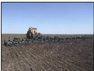
Борона БТ-18.М в агрегате с трактором К-701 на обработке парового поля
