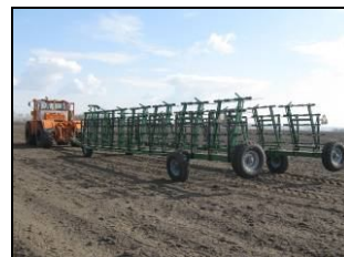
Борона средняя пружинная БС-24М в агрегате с трактором К-700А в транспортном положении
