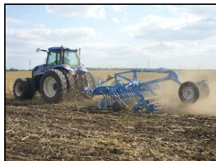
Борона дисковая БД-6 в агрегате с трактором New Holland TG 285 на дисковании стерни пожнивных остатков подсолнечника
