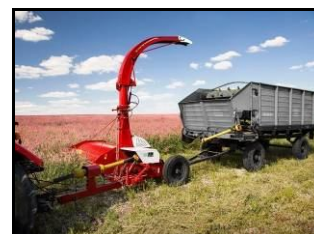
Комбайн кормоуборочный полуприцепной КСД-2,0 с погрузкой измельченной массы в кормораздатчик
