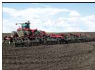
Полевой культиватор SALFORD 580-40 в агрегате с трактором «Versatile 2375» в рабочем положении
