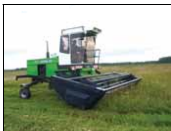
Самоходная косилка-плющилка Е-403 «Мещера» в агрегате с жаткой SH-025
