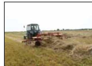
Грабли-ворошилка роторные ГВР-6Р в агрегате с трактором «Беларус 82.1» в работе
