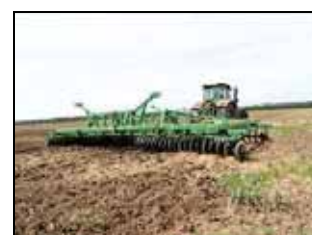
Трактор АТМ 7360 в агрегате с бороной БД-9,3 на дисковом лущении стерни озимой пшеницы
