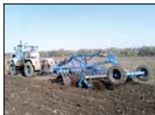
Агрегат дисковый АД-4 в агрегате с трактором Т-150К в работе
