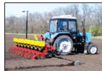
Пневматическая сеялка точного высева MS 4100 в агрегате с трактором МТЗ-82.1 на посеве подсолнечника
