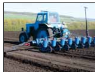
Сеялка пропашная SPP-8 в агрегате с трактором MT3-80
