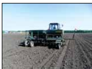
Сеялка СУЗТ-4 в агрегате с трактором «Беларус 1221» в работе
