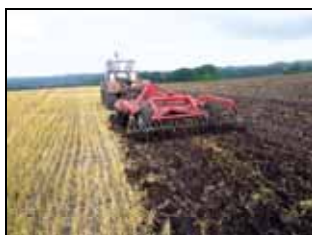
Борона дисковая модульная прицепная Антарес БДМП-3х4-04 в работе с трактором Т-150К
