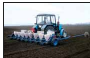
Универсальная пневматическая сеялка УПС-8 в агрегате с трактором МТЗ-82.1 на посеве подсолнечника
