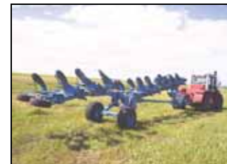
Плуг ППО-6+3 в агрегате с трактором К-744РЗ в транспортном положении
