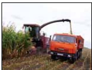
Комбайн самоходный кормоуборочный КВК-6025 на уборке кукурузы на силос
