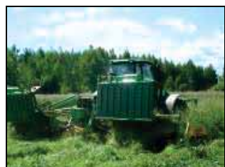
Комплекс косилок «Giga CUT» KDD 861ST с косилкой фронтальной KDF 300S в агрегате с трактором «Deutz Fahr «Agrotron 165,7» в работе с поднятыми транспортерами
