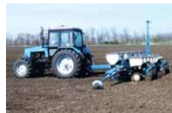
Сеялка точного высева механическая Kinze 3000 в агрегате с трактором МТЗ-1221 на посеве кукурузы на зерно
