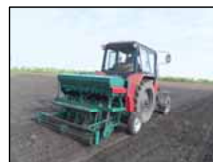
Сеялка СФС-2 в агрегате с трактором МТЗ-82.1 в работе
