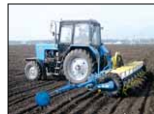
Сеялка точного высева пневматическая СТП-8 «Ритм-1МТ» в агрегате с трактором МТЗ-82.1 на посеве подсолнечника
