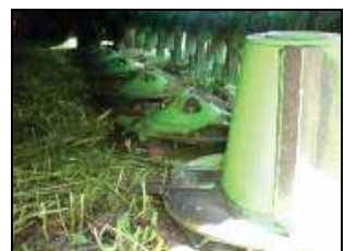
Комплекс косилок «Giga CUT» KDD 861ST с косилкой фронтальной KDF 300S. Режущий и бильный плющильный аппарат
