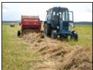
Пресс-подборщик рулонный ПР-145С в работе в агрегате с трактором «Беларус 82.1»
