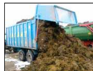
Полуприцеп с подпрессовкой ПСП-15 при разгрузке измельченной массы
