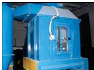
Колонна охлаждения ОКТ-1,5. Секция охлаждения
