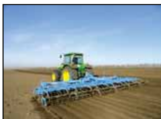
Культиватор Korund 8/900 К в агрегате с трактором «Джон Дир 8420» на предпосевной культивации
