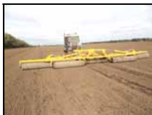
Каток ККЗ-10В в агрегате с трактором «Агромаш 90ТГ» в работе
