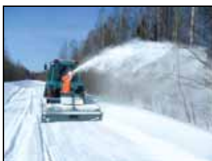
Снегоочиститель в агрегате с трактором МТЗ-82 в работе на очистке дороги от снега
