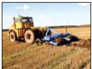
Плуг чизельный навесной ПЧН-4,5 в агрегате с трактором К-701 в работе
