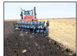
Плуг ППО-6+3 в агрегате с трактором К-744РЗ в работе
