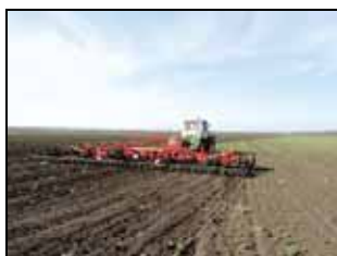
Культиватор ШККС-10 в агрегате с трактором Т-150К на предпосевной культивации
