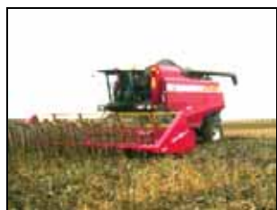
Приспособление для уборки подсолнечника НАШ-1273-04 в работе в агрегате с комбайном КЗС-1218
