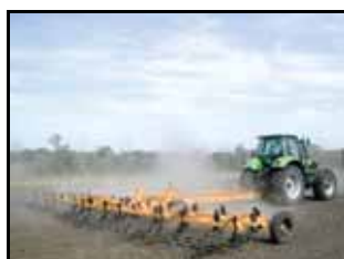
Культиватор КПП-12В в работе на культивации пара в агрегате с трактором «Agrotron 265»
