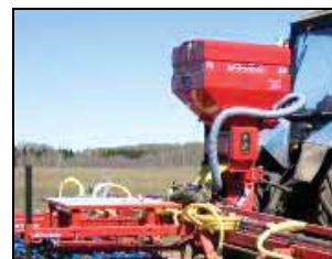
Борона сетчатая «Штригель» с бункером «Air». Высевальным пневматическим аппаратом
