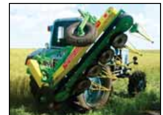
Машина тербления льна МТЛ-1,5 в агрегате с трактором МТЗ-82 в транспортном положении
