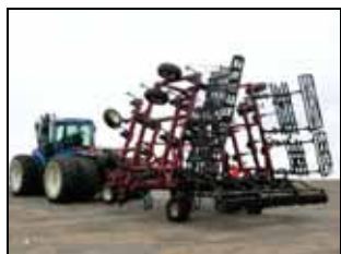
Полевой культиватор SALFORD 580-40 в агрегате с трактором «New Holland 8050» в транспортном положении
