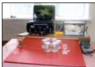
СМИ-5 в работе по облучению магнитными импульсами эксплантов малины (в стаканчиках на индукторе ПСИ-1
