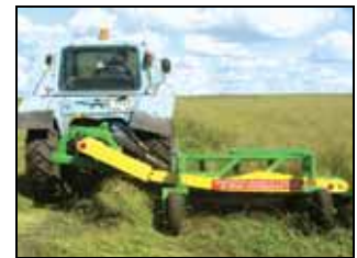
Машина тербления льна МТЛ-1,5 в агрегате с трактором МТЗ-82 в работе
