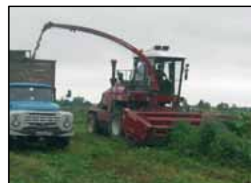
Комбайн кормоуборочный самоходный К-Г-6 с жаткой для трав в работе
