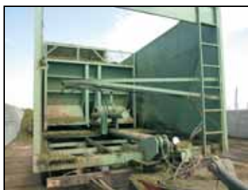
Механизм выгрузки (вид спереди кузова)
