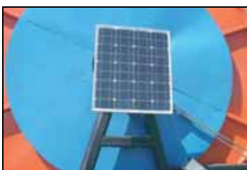
Солнечная батарея оросительной машины
