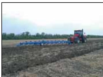
Трактор К-744Р4 в агрегате с плугом ПП-(9+2)х35 (11- корпусный вариант)
