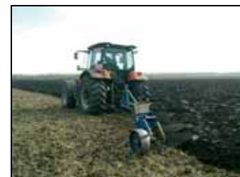
Трактор АТМ 3180М в агрегате с плугом ПСК-6 на отвальной вспашке почвы
