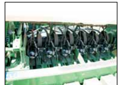
Вязальный аппарат с шестью узловязателями, приводом и системой обдува
