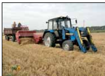
Пресс-подборщик тюковый ППТ-041 в агрегате с трактором МТЗ-82.1, в работе
