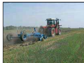
Плуг ПЧП-4,5 в агрегате с трактором «VERSATILE 2375» на осенней глубокой обработке почвы
