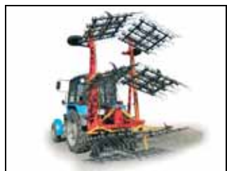
Борона штригельная БШ-9Н в агрегате с трактором МТЗ-82 в транспортном положении, вид сзади слева
