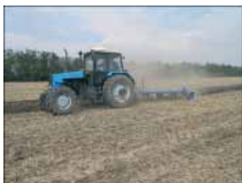
Плуг ПНР-(3+1)х45П в агрегате с трактором «Беларус 1221.2» на вспашке стерни озимой пшеницы
