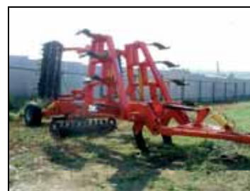
Плуг ПЧ-6ПК в транспортном положении
