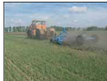
Плуг ПЧП-4,5 в агрегате с трактором К-701 на осенней глубокой обработке почвы
