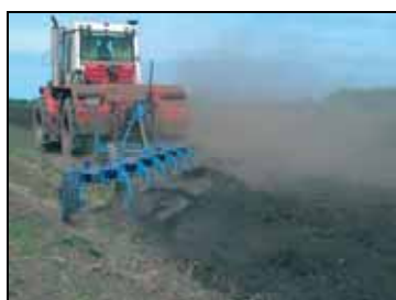
Плуг ПНГ-8-50К в агрегате с трактором К-744Р3 в работе
