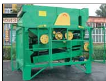
Очиститель зерна фракционный ОЗФ-50 (привод рабочих органов)
