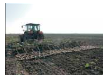
Трактор АТМ 3180М в агрегате с культиватором КПК-8А на сплошной культивации почвы
