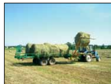
Погрузчик-транспортировщик рулонов ТП-10 в агрегате с трактором МТЗ-82 при погрузке рулонов
