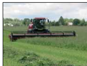
Косилка самоходная КС-200 в работе на скашивании многолетних трав
