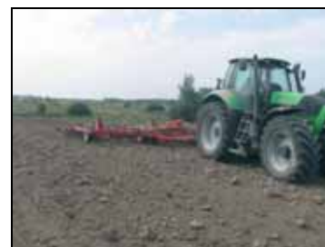
Борона пружинная – культиватор БПК-8 в агрегате с трактором «Agrotron-265» в работе
