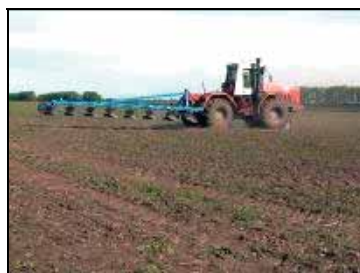
Плуг ПНГ-8-50К в агрегате с трактором К-744Р3 в транспортном положении
