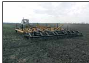
Культиватор «Престиж» К1 7.0 в агрегате с трактором Т-150К на сплошной обработке почвы
