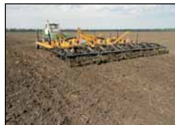
Культиватор «Престиж» К1 7.0 в агрегате с трактором Т-150К на предпосевной обработке почвы
