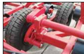
Механизм подката двух спаренных ходовых колес на центральной раме
