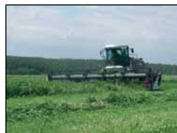
Косилка самоходная универсальная КСУ-1 с жаткой-хедером транспортной ЖХТ 9-18 в работе
