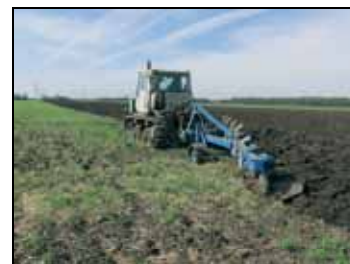
Плуг ПНУ-5х35УП в агрегате с трактором Т-150 на отвальной вспашке почвы
