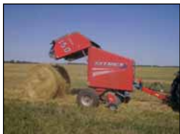
Вид рулона соломы на выходе из прессовальной камеры пресс-подборщика Action 150
