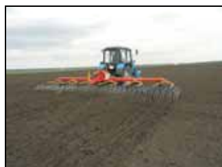
Борона штригельная БШ-9Н в агрегате с трактором МТЗ-82 на довсходовом бороновании посевов сои
