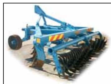
Плуг чизельный ПЧМ-4 в рабочем положении, вид сзади слева
