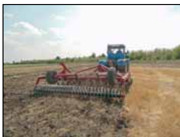
Борона дисковая модульная прицепная БДМП-4х4-04 в работе
