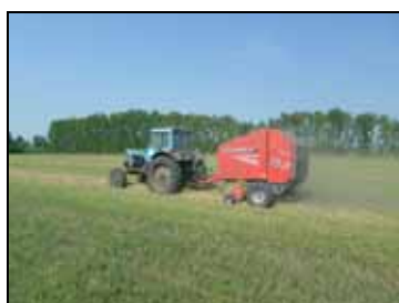
Пресс-подборщик рулонный Action 150 с трактором МТЗ-82 на подборе валков соломы
