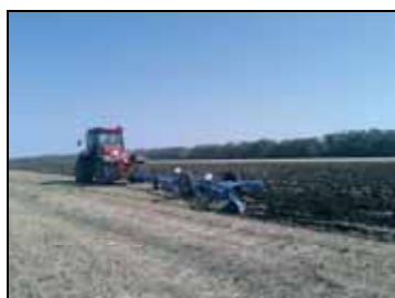
Трактор К-744Р4 в агрегате с плугом ПП-(9+2)х35 (9-корпусный вариант)
