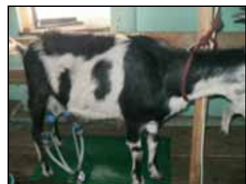
Доильный аппарат ДАД-01К в работе
