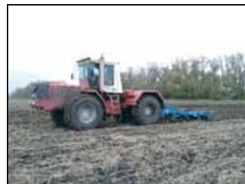
Плуг чизельный ПЧМ-4 в агрегате с колесным трактором К-744РЗ в работе, вид спереди слева
