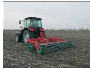
Дисковый лущильник UNIA ARES 4TXL в агрегате с трактором «Беларус 1523» на дисковом лущении стерни подсолнечника (второй след)
