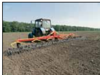
Борона штригельная БШ-9Н в агрегате с трактором МТЗ-82 на повсходовом бороновании подсолнечника
