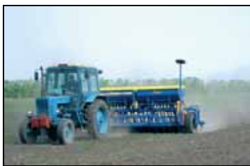
Сеялка зернотуковая рядовая СЗР-5,4 в агрегате с трактором МТЗ-80 в работе
