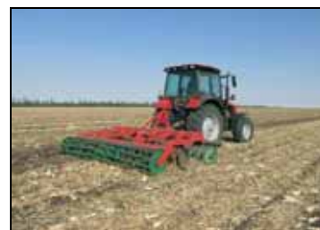
Дисковый лущильник UNIA ARES 4TXL в агрегате с трактором «Беларус 1523» на дисковом лущении стерни кукурузы (первый след)
