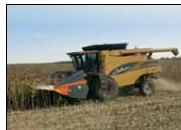
Приспособление OptiSun-870-PSM в агрегате с самоходным зерноуборочным комбайном «Challenger 660» на уборке подсолнечника
