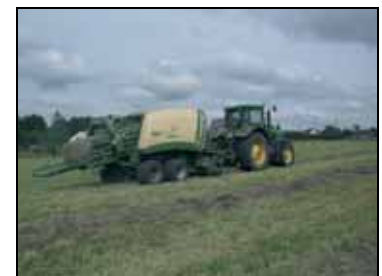
Пресс-подборщик BIG PACK 1270 ХС в агрегате с трактором «JOHN DEERE 7820» на подборе валков сена
