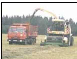
Комбайн кормоуборочный самоходный BIG X 600/1 в работе
