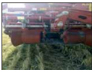
Секция подкапывания клубней картофеля комбайна BR-150
