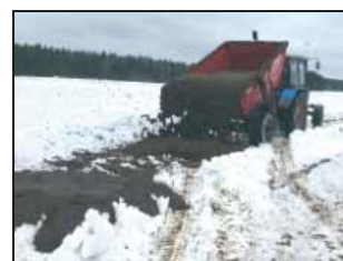
Полуприцеп самосвальный ПС-7 в агрегате с трактором Беларус 82.1 в работе на выгрузке полужидких удобрений
