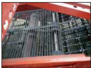
Сепарирующие элеваторы комбайна BR-150
