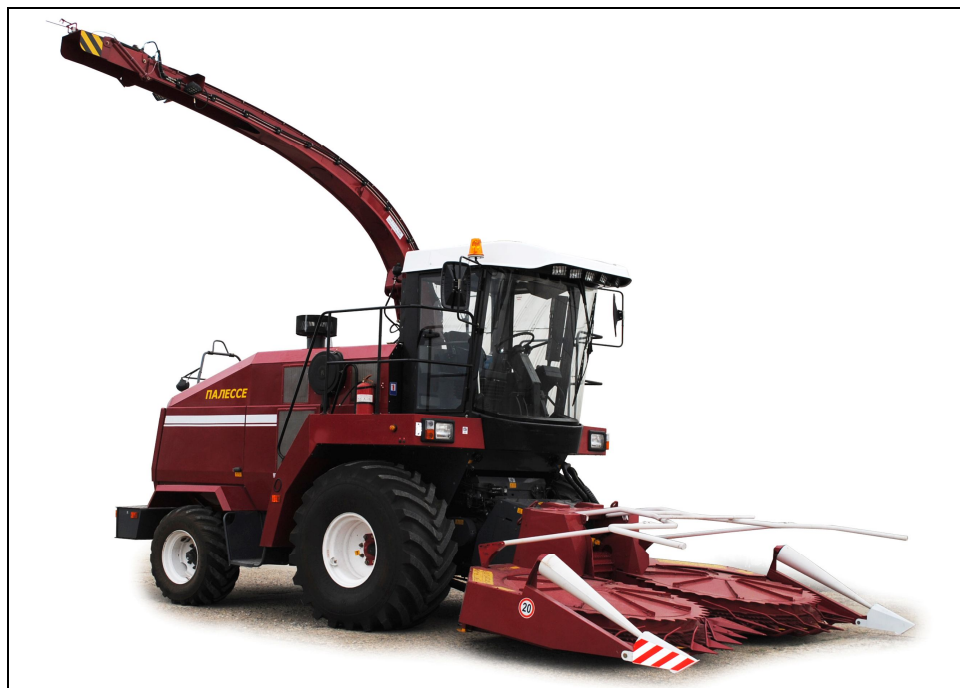
Рисунок 2 – Жатка для грубостебельных культур ЖГР-4,5-1Е в агрегате с комбайном кормоуборочным самоходным высокопроизводительным КВК-800-39, в рабочем положении, вид спереди справа
