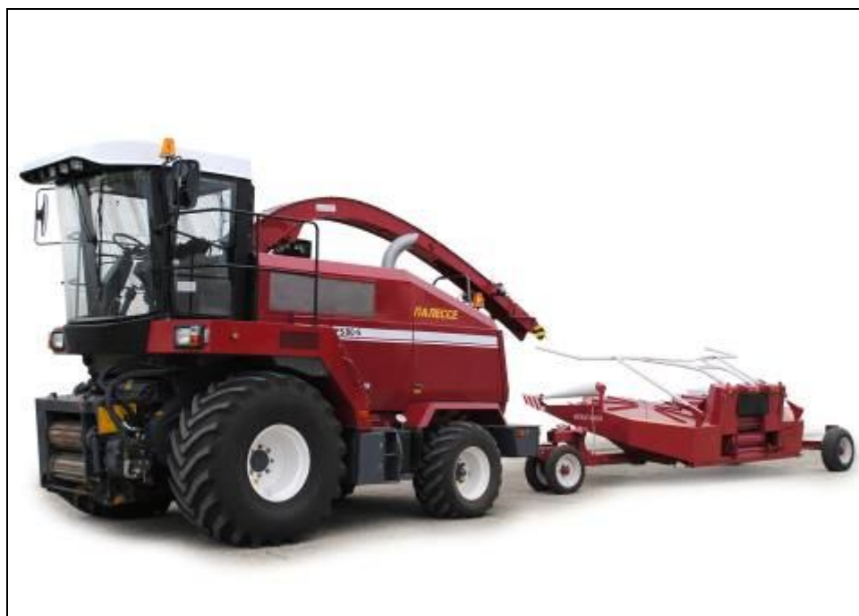
Рисунок 3 – Жатка для грубостебельных культур ЖГР-4,5-1Е (установленная на транспортную тележку) в агрегате с комбайном кормоуборочным самоходным высокопроизводительным КВК-800-39, в транспортном положении, вид спереди слева
