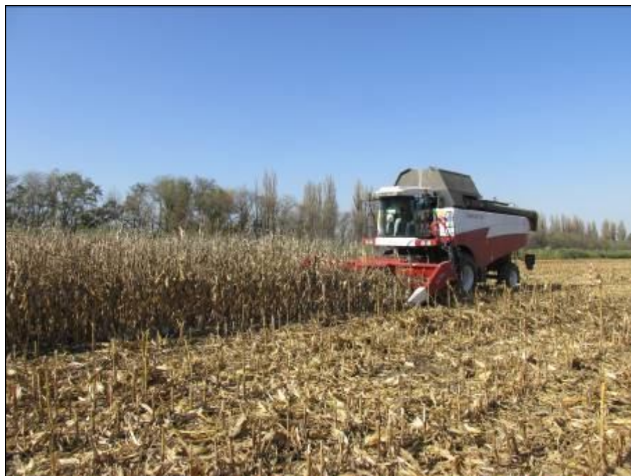
Рисунок 12 – Жатка для уборки кукурузы RSM MS-870-49 в агрегате с комбайном РСМ-181 "TORUM-750" на уборке кукурузы на зерно
