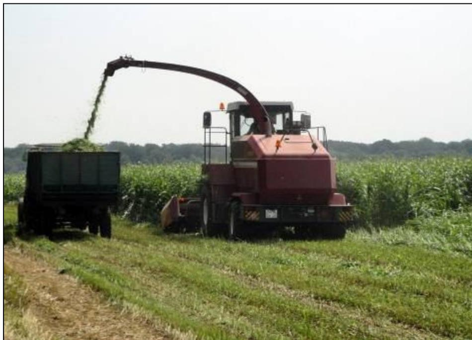
Рисунок 5 – Жатка для уборки трав КВК-6025.12-02 в агрегате с комбайном кормоуборочным самоходным высокопроизводительным КВК-800-39, в работе на скашивании суданской травы
