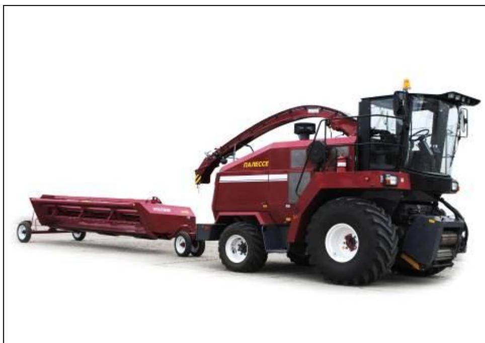
Рисунок 4 – Жатка для уборки трав КВК-6025.12-02 в агрегате с комбайном кормоуборочным самоходным высокопроизводительным КВК-800-39, в транспортном положении, вид спереди справа
