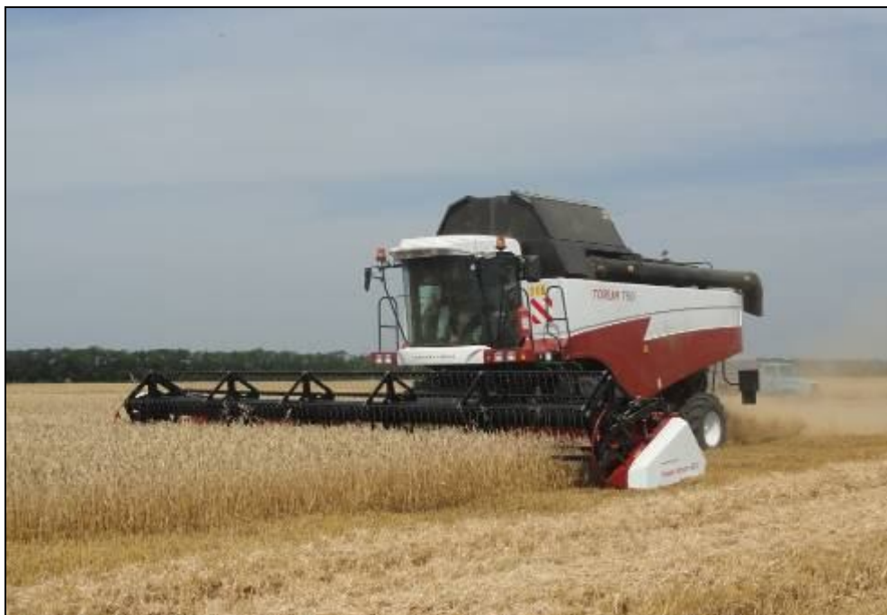
Рисунок 2 – Жатка РСМ-081.27-47 с комбайном зерноуборочным РСМ-181 "TORUM-750" в работе на прямом комбайнировании озимой пшеницы
