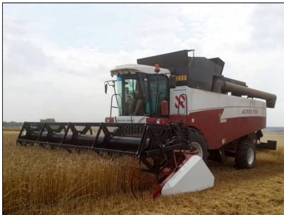
Рисунок 2 – Жатка РСМ-081.27-34 с комбайном зерноуборочным РСМ-142 "ACROS-550", на прямом комбайнировании озимой пшеницы
