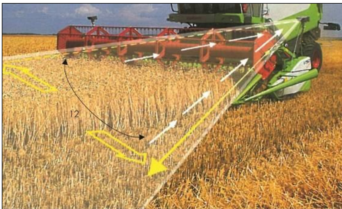
Рисунок 2 – Схема работы электронно-оптического прибора системы LASER PILOT
