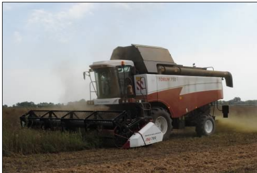
Рисунок 2 – Жатка ЖСУ-700 в агрегате с зерноуборочным комбайном РСМ-181 "TORUM 750", на уборке сои
