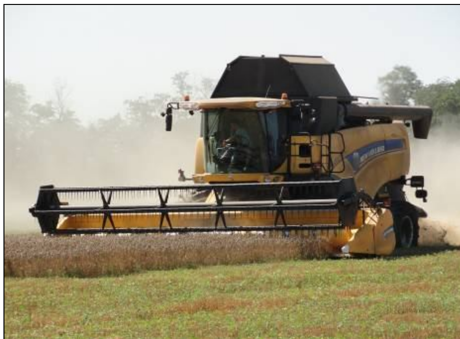
Рисунок 2 – Жатка зерновая 740 CF-25 SUPERFLEX, с комбайном New Holland CX 8080 на прямом комбайнировании озимой пшеницы
